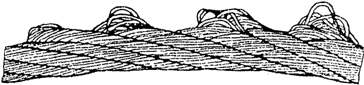
Рис. 14. Выдавливание проволок прядей:
