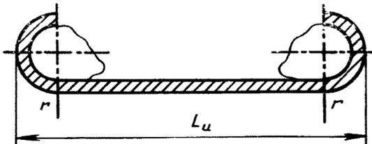
Расстояние  $rr$ , мм, равно утроенному шагу крутки;  $r$  — ограничивающие отметки для стандартного испытания;  $L_u$  — эффективная длина, измеренная без натяжения, испытуемый отрезок просто расправлен.
