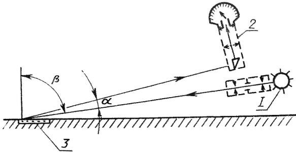
1—осветитель; 2—фотоприемник; 3—образец дорожной разметки или эталон;  $\alpha=1^{\circ}30'$ ;  $\beta=88^{\circ}$
