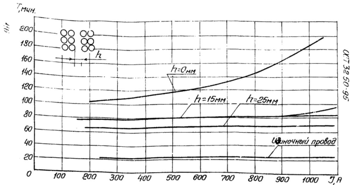
Рисунок Б.6 - Зависимость постоянной времени наиболее нагретого провода в укладке  $4 \times 3$  с вертикальными зазорами  $h=0$  мм,  $h=15$  мм,  $h=25$  мм от тока нагрузки,  $t_0=40^\circ\text{C}$ ,  $v=0,48\text{ м/с}$ ,  $S=240\text{ мм}^2$
