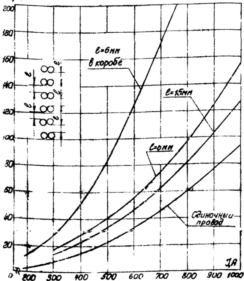
Рисунок 5.8 - зависимость установившихся температур наиболее нагретого провода в кладке 2-б открытой с зазорами  $l=6\text{ мм}$ ,  $l=15\text{ мм}$  и в коробе ( $l=6\text{ мм}$ ) от тока нагрузки,  $t_0=40^\circ\text{C}$ ,  $V=0,48\text{ м/с}$ ,  $S=240\text{ мм}^2$
