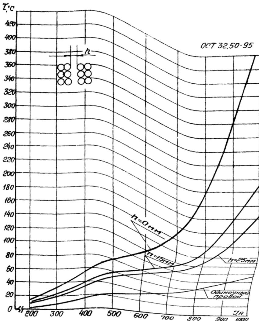
Рисунок Б.5.-Зависимость установившихся перепадов наиболее нагретого провода в укладке  $4 \times 3$  с вертикальными зазорами  $h=0\text{mm}$ ,  $h=15\text{mm}$ ,  $h=25\text{mm}$ , от тока нагрузки,  $t_v=40^\circ\text{C}$ ,  $V=0,48\text{ м/с}$ ,  $S=240\text{ мм}^2$
