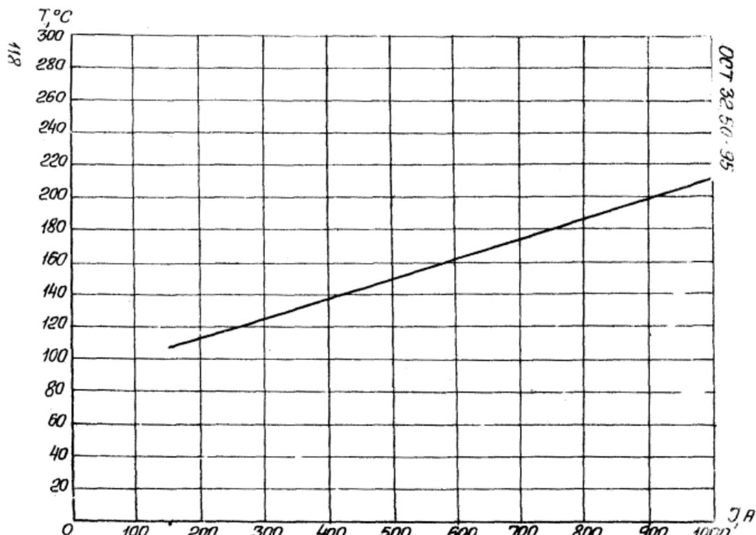
Рисунок 5.8 — Зависимость постоянной времени от тока нагрузки:
