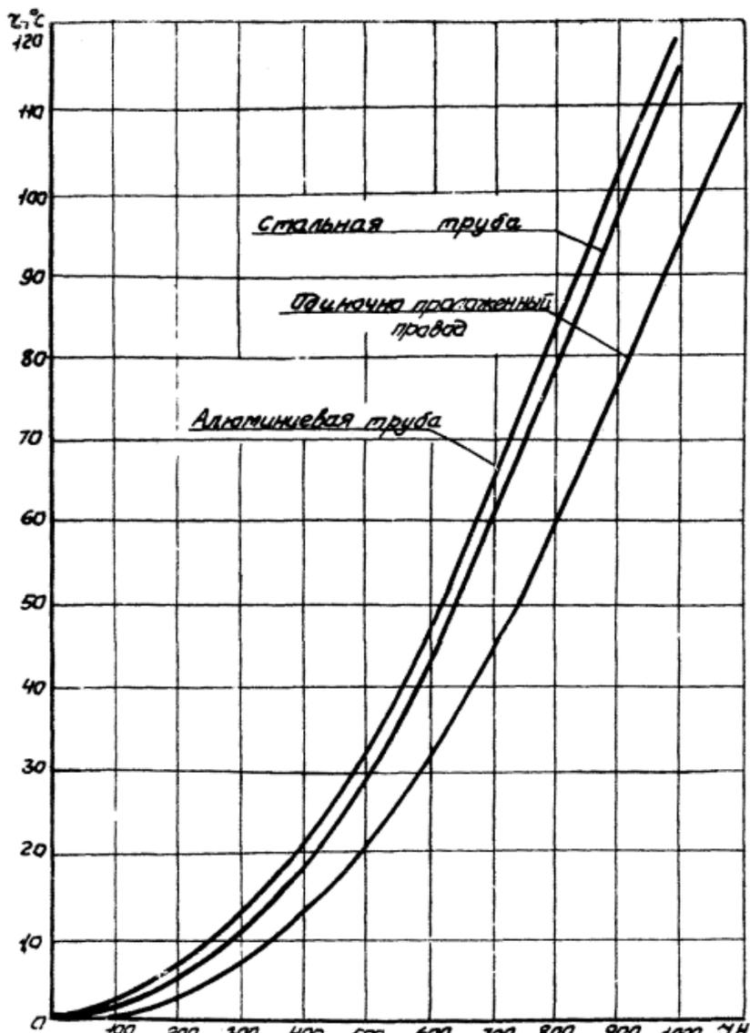
Рисунок Б.1 - Зависимость установившегося перегрева провода, вложенного в трубу, от температуры наружки  $t_0 = 40^\circ\text{C}$ ,  $v = 0,48 \text{ м}^2/\text{с}$ ,  $S = 240 \text{ мм}^2$
