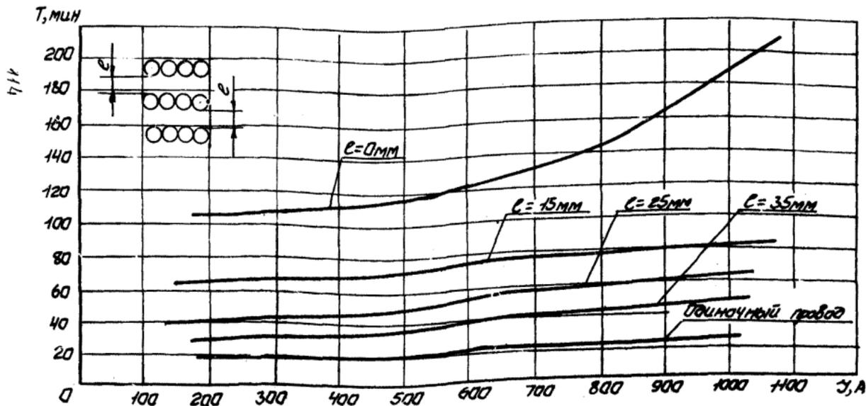
Рисунок Б.4- Зависимость постоянной времени наиболее нагретого провода в укладке 4x3 с горизонтальными зазорами  $l = 0$  мм,  $l = 15$  мм,  $l = 25$  мм,  $l = 35$  мм от тока нагрузки,  $t_0 = 40^\circ\text{C}$ ,  $\gamma = 0,18\%$ ,  $S = 240\text{ мм}^2$ .
