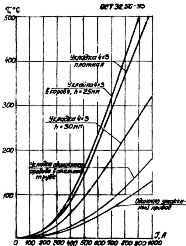
Рисунок Б11 - Зависимость установленных пределов перегрева провода от тока нагрузки и способа укладки при  $t_0 = 40^\circ\text{C}$  и  $V = 0,48\text{ м/с}$ ,  $S = 185\text{ мм}^2$
