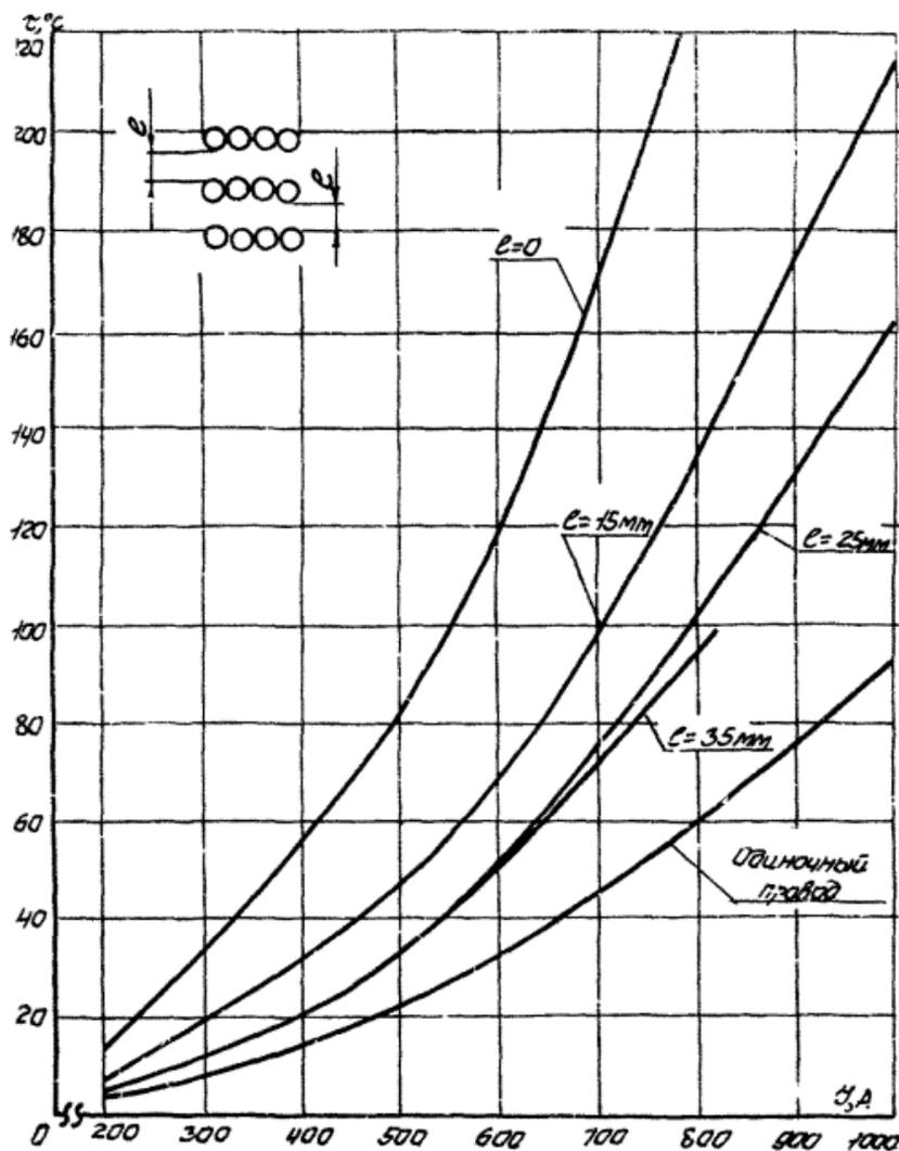
Рисунок Б.3— Зависимость установившихся перегревов наиболее нагретого провода в укладке 4x3 с горизонтальными зазорами  $l=0\text{mm}$ ,  $l=15\text{mm}$ ,  $l=25\text{mm}$ ,  $l=35\text{mm}$  от тока нагрузки,  $t_0=40^\circ\text{C}$ ,  $\gamma=0,48\text{ }^\circ\text{C}/\text{K}$ ,  $S=240\text{mm}^2$
