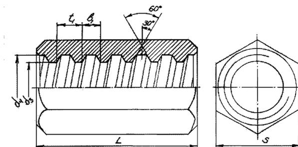
Рисунок 40 – Резьба соединительных элементов для арматуры винтового профиля.
