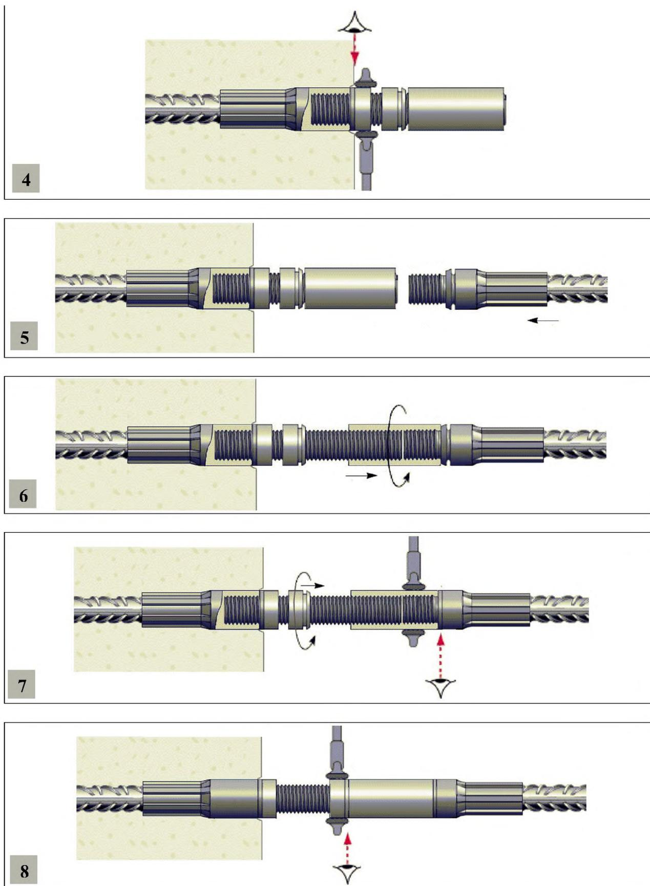
Рисунок 31 – Сборка позиционных комбинированных соединений
