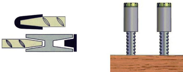
Рисунок 17 – Защитные изделия для муфт и стержней
