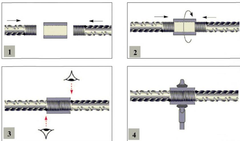
Рисунок 30 – Сборка позиционных соединений с разнонаправленной резьбой
