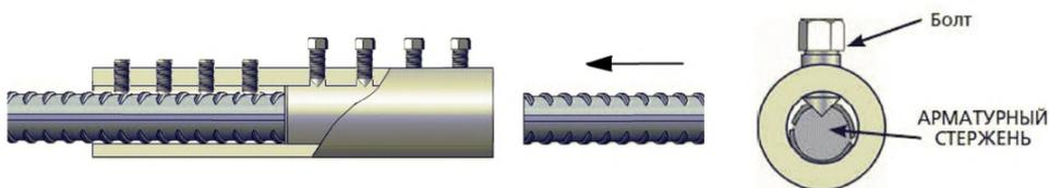
Рисунок 37 – Сборка стандартных механических соединений на болтах
