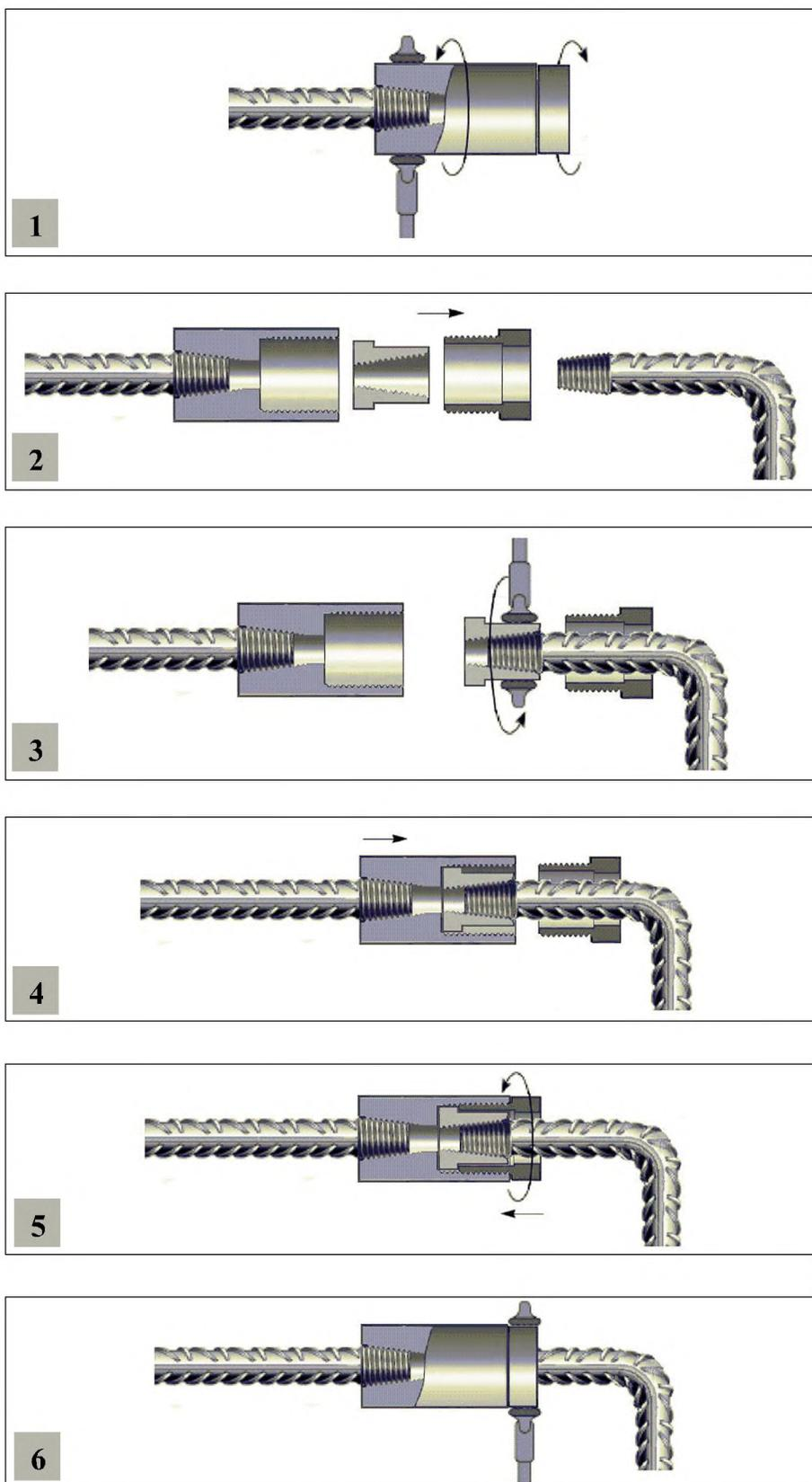
Рисунок 23 - Сборка позиционного соединения тип 2 с конической резьбой
