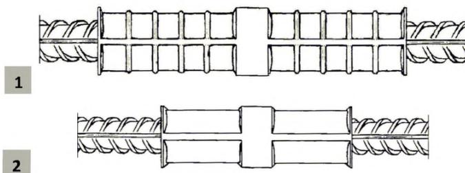
Рисунок Ж.1 – Опрессованный стык построечного изготовления, произведенный на мобильном оборудовании многократным поперечным деформированием соединительной муфты: 1- с промежутками, 2- без промежутков
