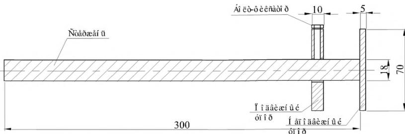
Рисунок 33 – Шаблон для устройства опрессованного стыка
