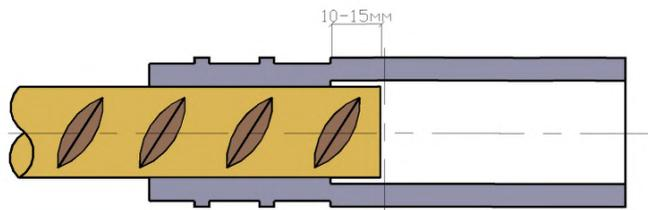
Рисунок 36 – Опрессованный стык, обжатый с одной стороны
