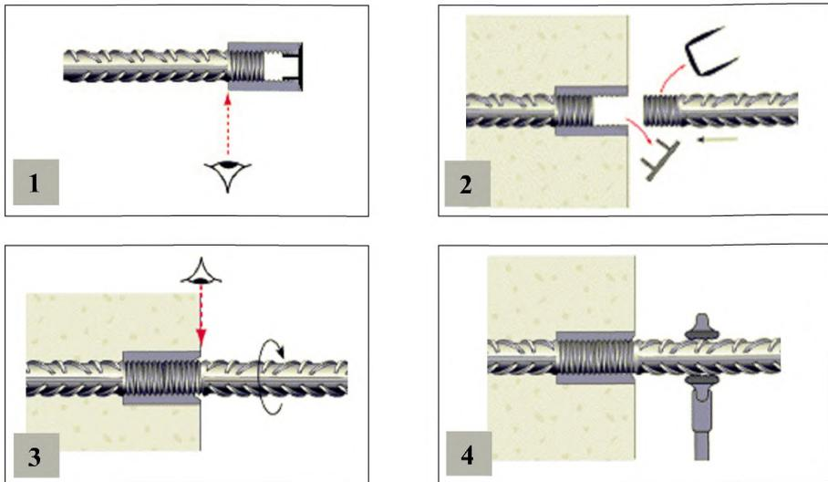
Рисунок 27 – Сборка стандартных соединений
