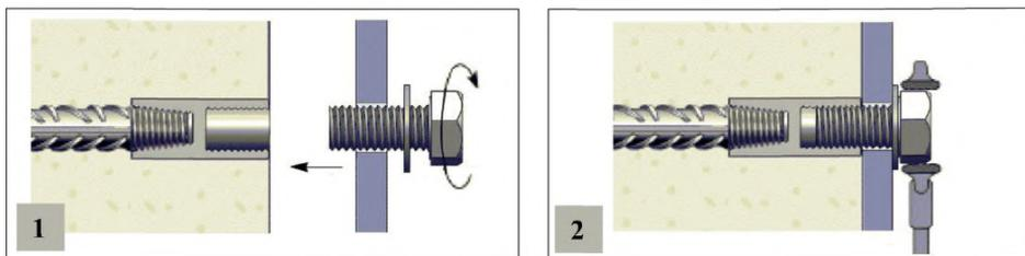
Рисунок 26 – Сборка болтовых соединений
