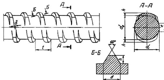
Рисунок 39 – Арматурный прокат с винтовым периодическим профилем
