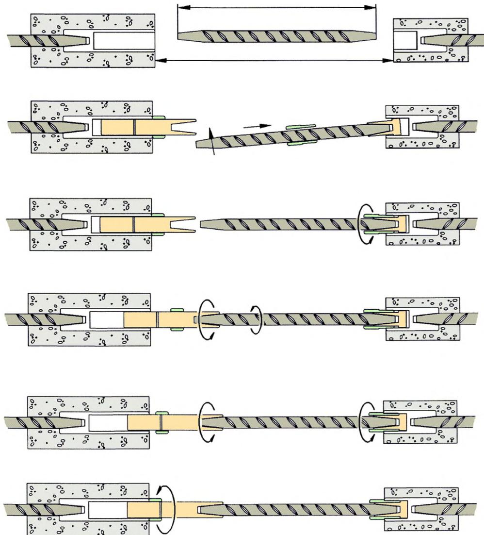
Рисунок 24 - Сборка позиционных соединений в конструкции.
