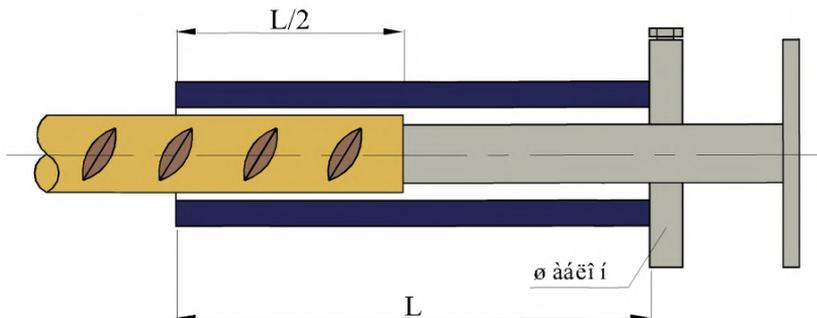
Рисунок 34 – Центровка арматуры с помощью шаблона
