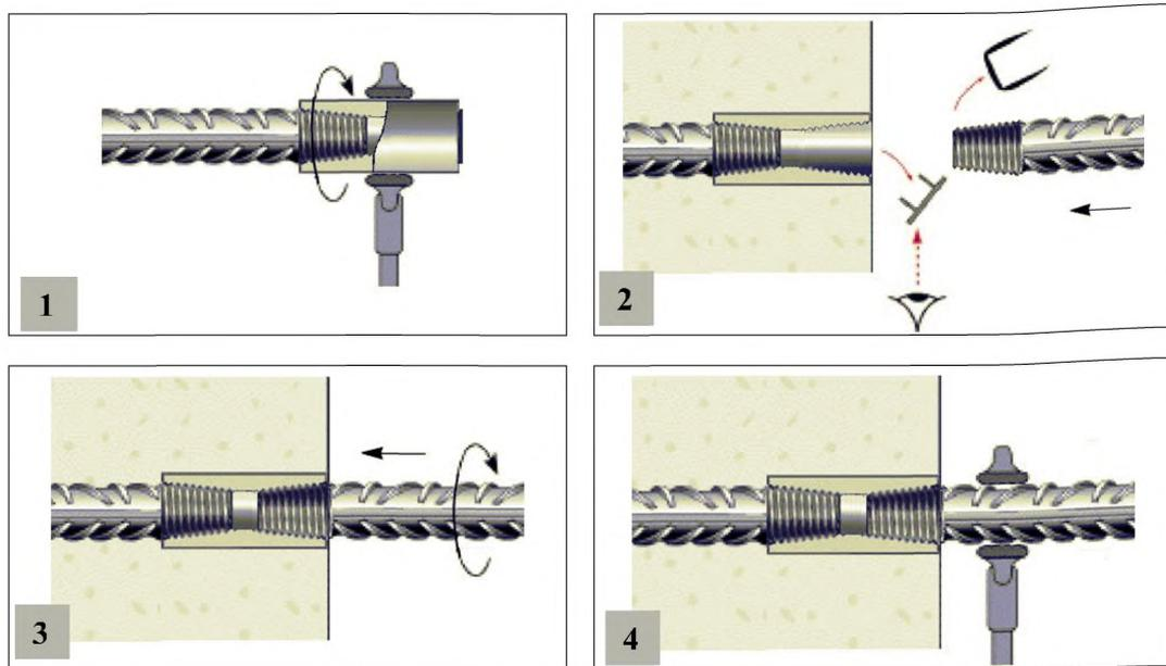
Рисунок 21 – Сборка стандартных соединений с конической резьбой
