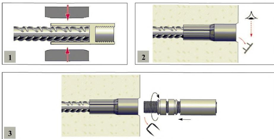
Рисунок 31 – Сборка позиционных комбинированных соединений
