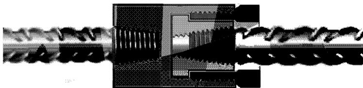
Рисунок 9 – Позиционное резьбовое соединение арматуры со стягивающим элементом
