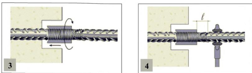
Рисунок 28 – Сборка позиционных соединений без контргайки
