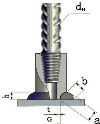
Рисунок И.1 – Конструкция и размеры тавровых соединений муфт с элементами плоского проката
