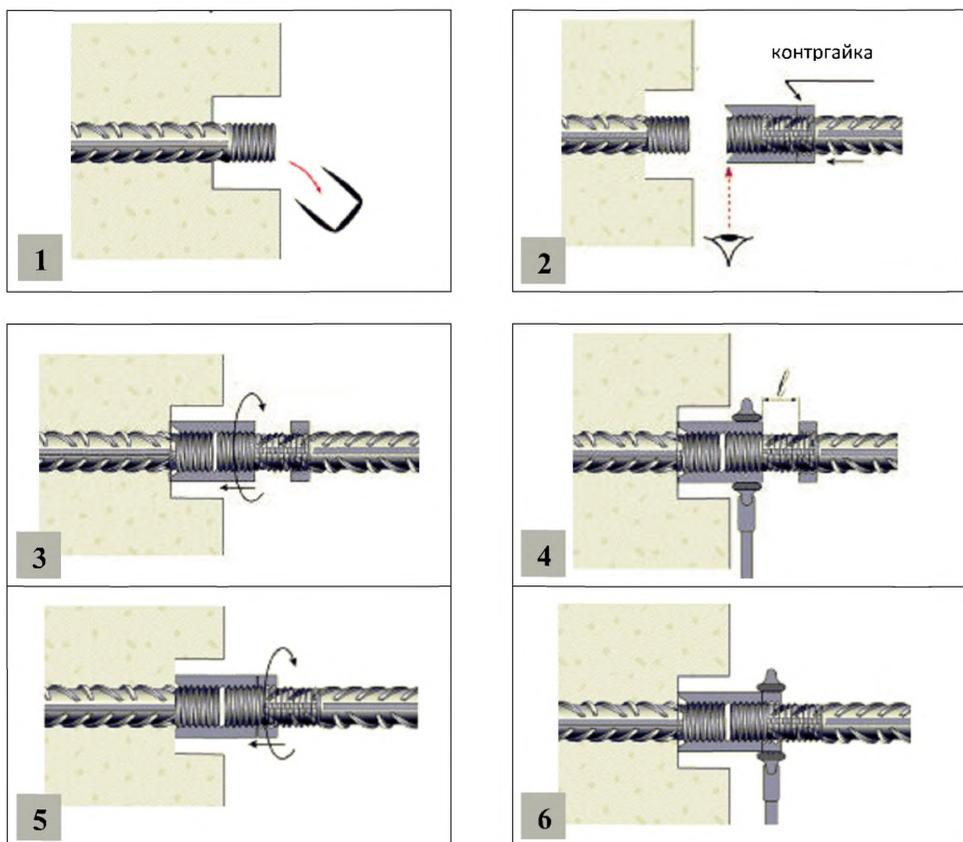
Рисунок 29 – Сборка позиционных соединений с контргайкой
