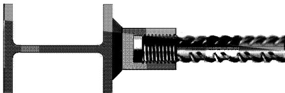
Рисунок 12 – Привариваемое резьбовое соединение арматуры
