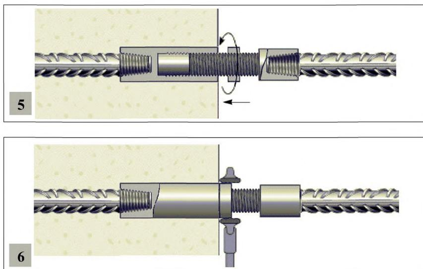
Рисунок 22 – Сборка позиционного соединения тип 1 с конической резьбой
