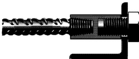
Рисунок 13 – Резьбовое соединение арматуры под метрический болт
