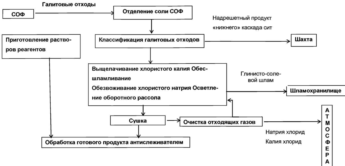
Рисунок 9.1— Принципиальная схема производства соли Камской поваренной, концентрата минерального «Галит» марки «А», концентрата минерального «Галит» (состав ПГМ)
