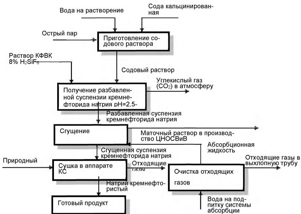
Рисунок 6.1 Принципиальная технологическая схема получения КФН из КФВК и соды.
