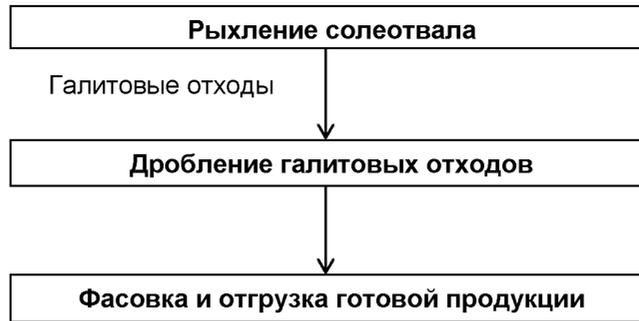
Рисунок 9.2 — Принципиальная схема производства натрия хлористого технического карьерного, концентрата минерального «Галит» марки «Б»
