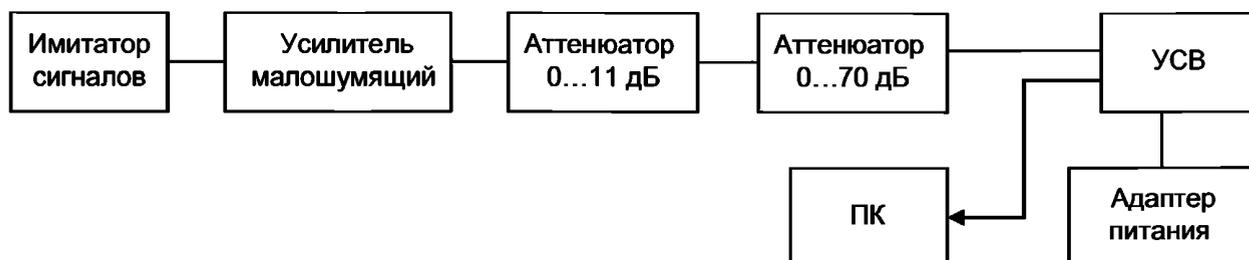
Рисунок В.3 — Схема определения чувствительности модуля ГНСС
