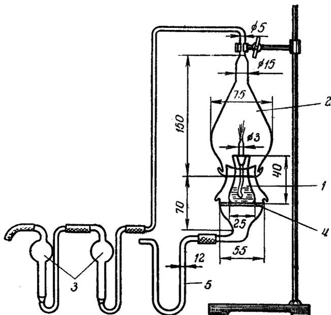
Рис. 14. Схема лампового прибора для определения хлор-органических соединений:
