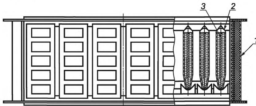
1 — корпус глушителя; 2 — кассета шумоглушения; 3 — звукопоглощающий материал
