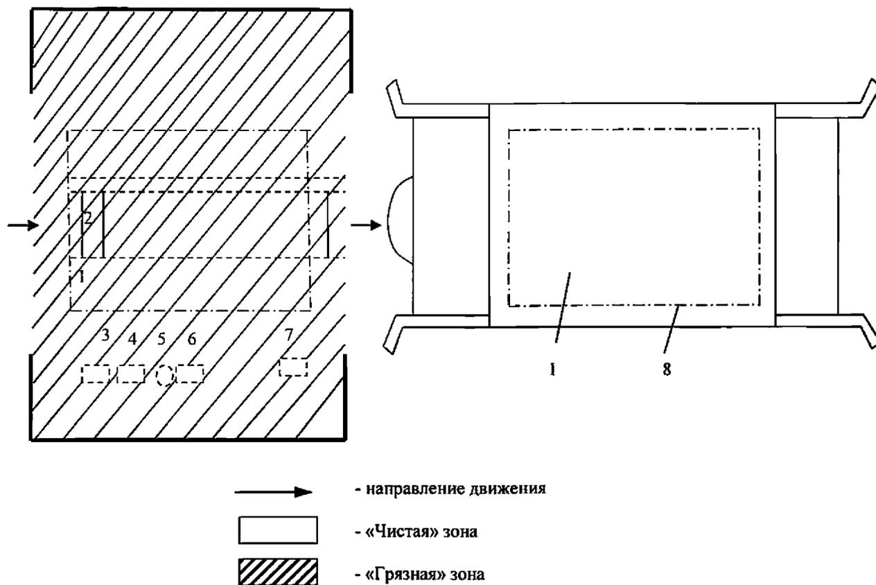
1 - рабочий пост, пост дозиметрического контроля; 2 - смотровая канава; 3 - ларь для обтирочных материалов; 4 - стол для деталей; 5 - емкость металлическая для приготовления растворов при специальной обработке; 6 - установка для мойки шланговая; 7 - установка для мойки двигателей снаружи; 8 - эстакада
