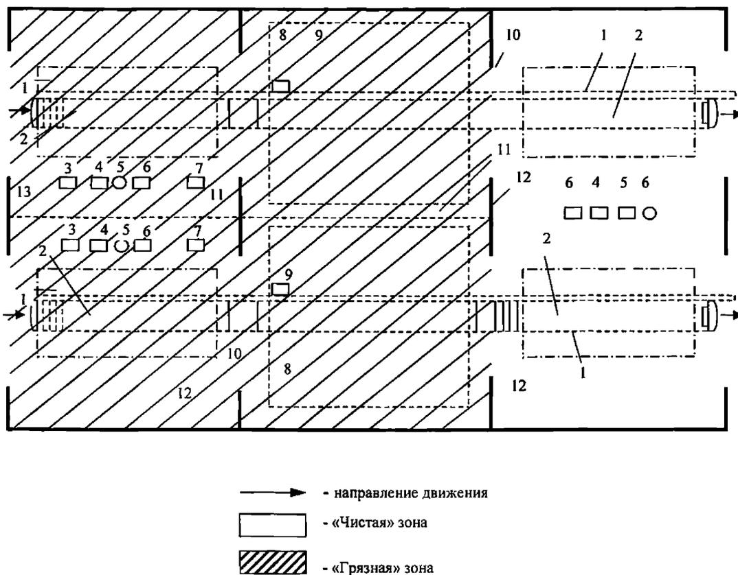
1 - рабочий пост, пост дозиметрического контроля; 2 - осмотровая канава; 3 - стол для деталей;
