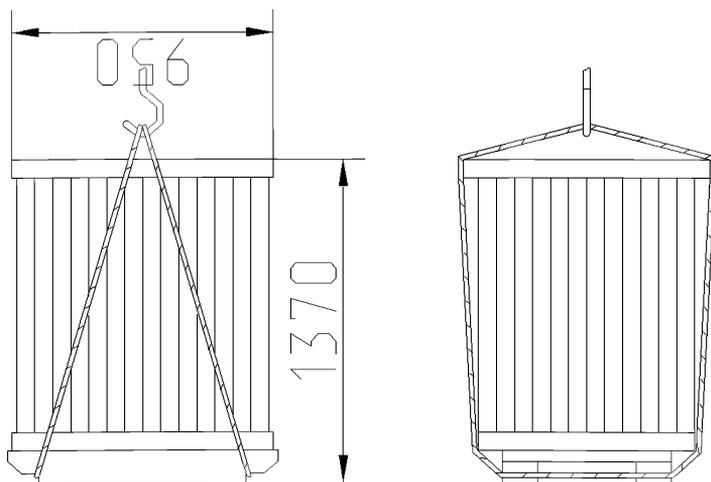
Рис. 2.5.7. Схема транспортировки машины стирально-отжимной ЛО-7
