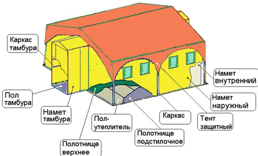
Рис. 2.1.3. Устройство палатки с наружным каркасом типа СМ.ПКн
