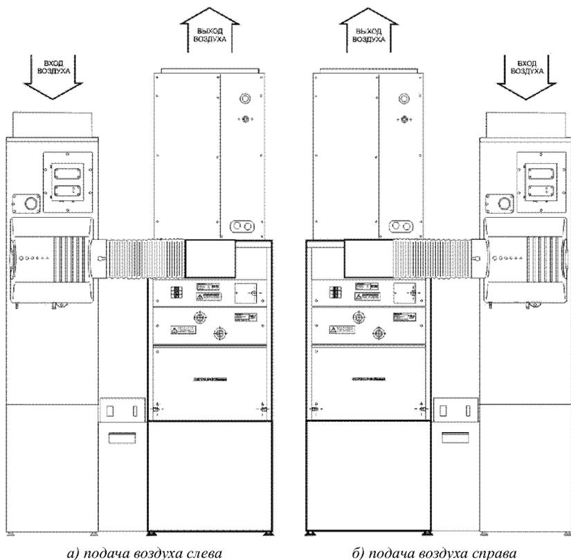
*Рис. 2.2.6. Возможные направления подачи воздуха в воздушонагреватель воздушного отопления «АНТАРЕС-Комфорт»*
