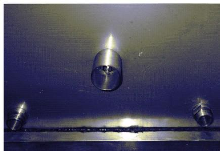
*Рис. 2.4.6. Вворачивание датчиков нижнего, среднего и верхнего уровней*
