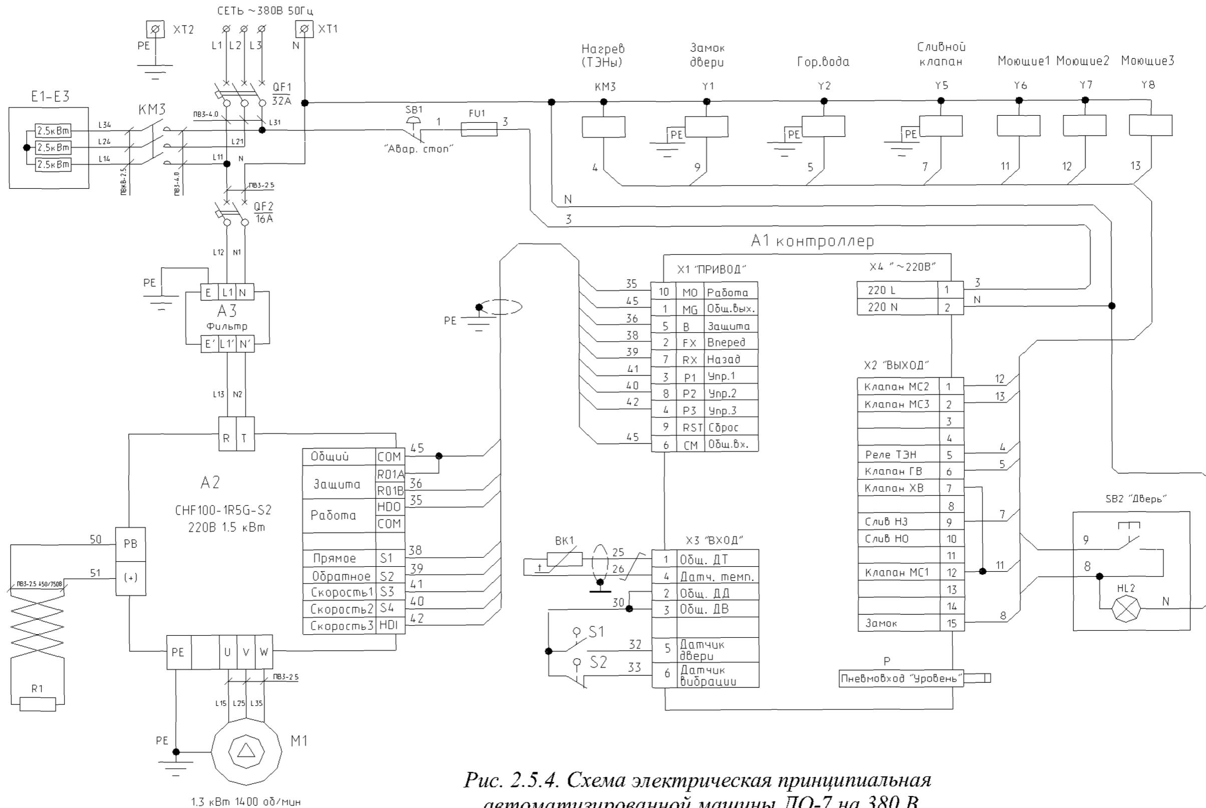
Рис. 2.5.4. Схема электрическая принципиальная автоматизированной машины ЛО-7 на 380 В
