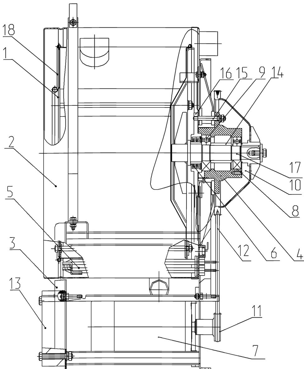
Рис. 2.5.2. Барабаны машин стирально-отжимных ЛО-7, ЛО-10:
