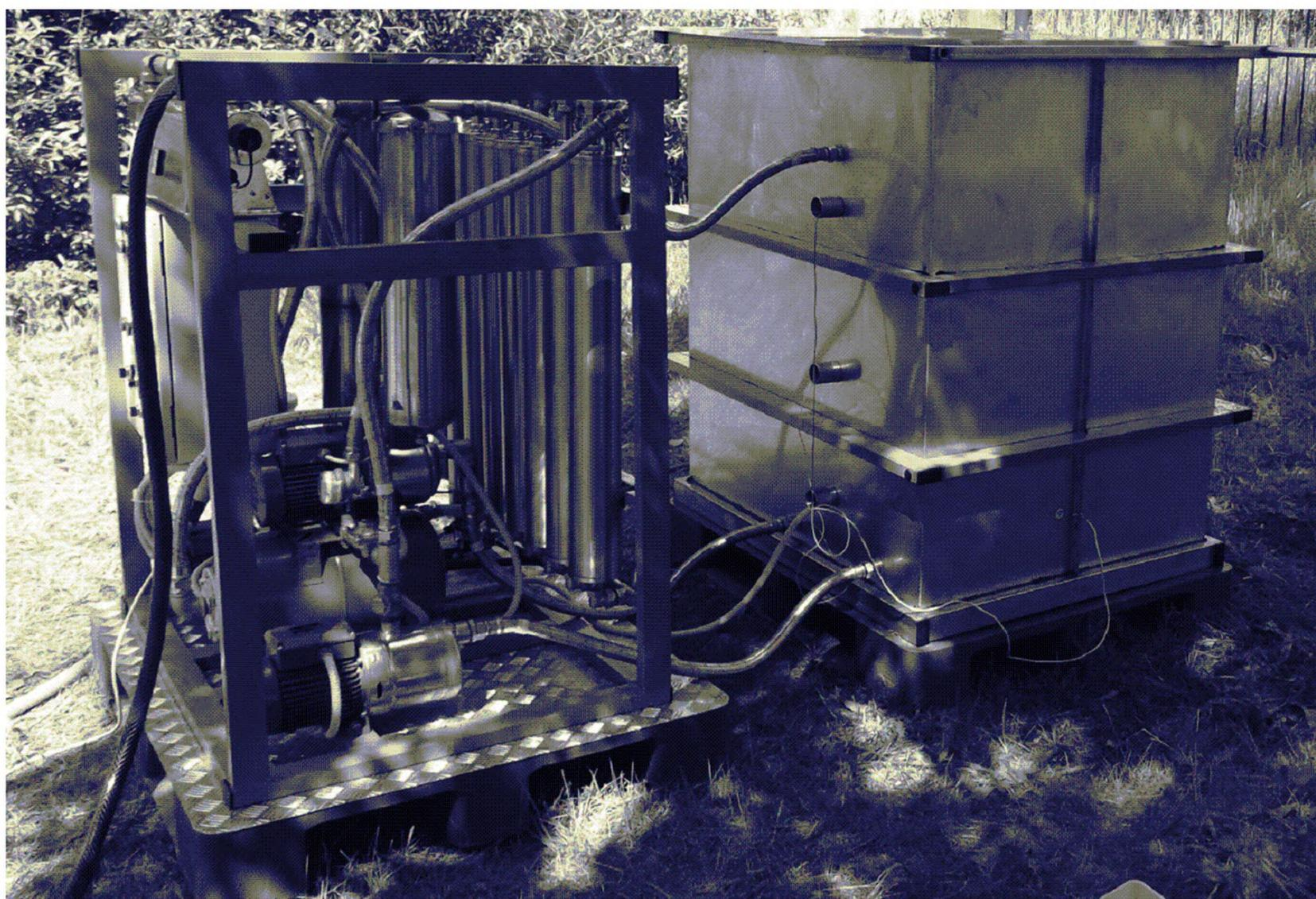
*Рис. 2.4.8. Подсоединение шлангов выдачи чистой воды и промывки*
