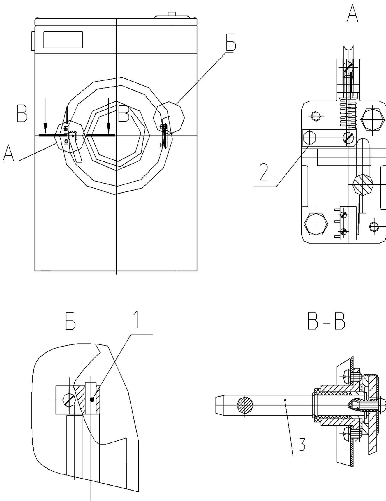
Рис. 2.5.5. Схема смазки машины стирально-отжимной ЛО-7:
