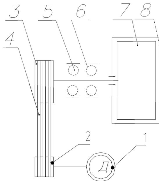
Рис. 2.5.6. Кинематическая схема машины стирально-отжимной ЛО-7:
