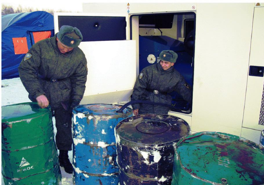
*Рис. 2.3.5. Заправка дизель-генераторной установки FG Wilson P500P3 топливом*
