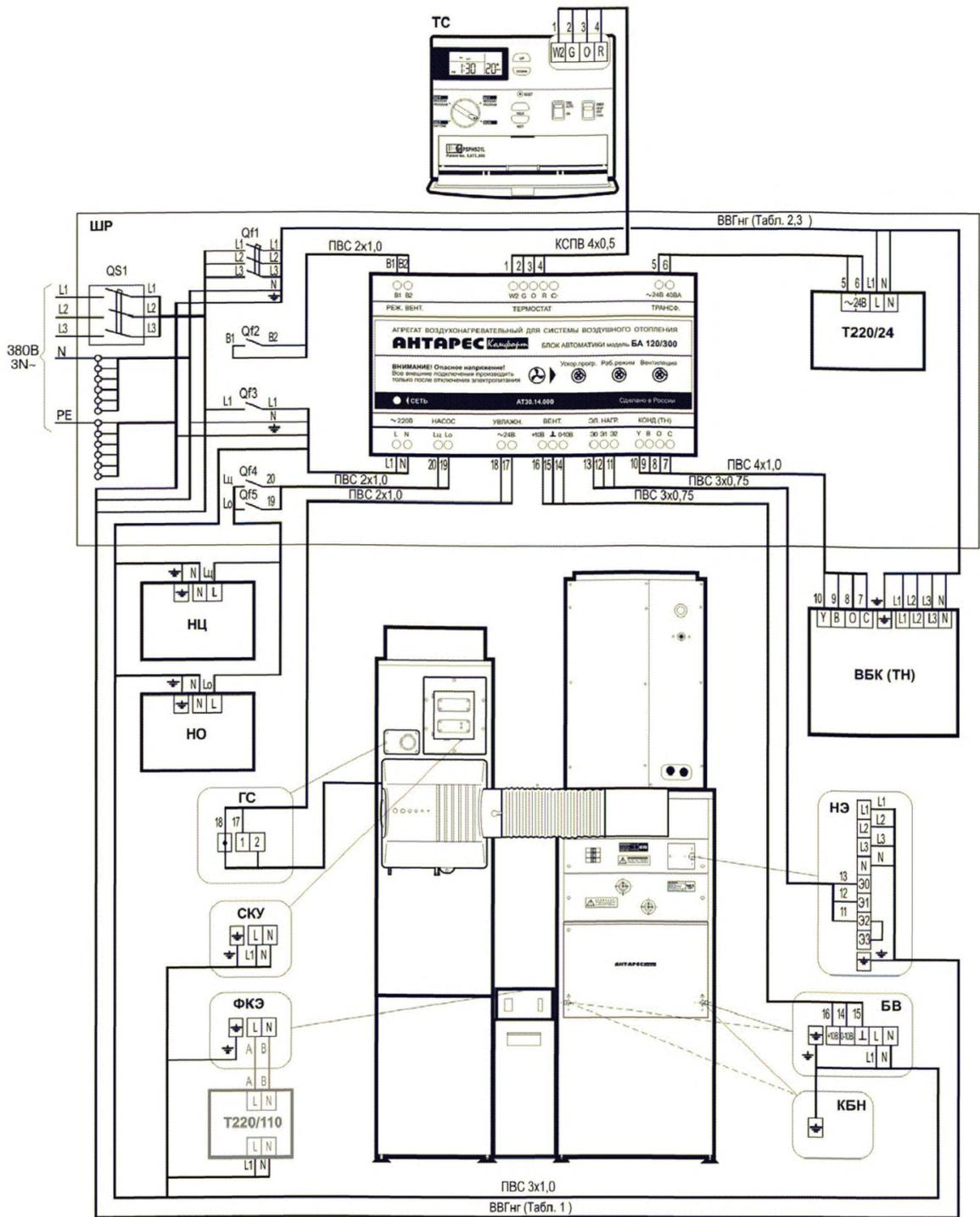
Рисунок 2.2.7. Схема подключения электрических цепей
