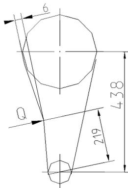
*Рис. 2.5.8. Схема натяжения ремней машины стирально-отжимной ЛО-7. Прогиб ветви ремня должен быть  $6 \pm 1$  мм при усилии  $Q = 5,5 \pm 0,5$  Н для нового ремня и  $Q = 4,5 \pm 0,5$  Н для приработанного ремня*
