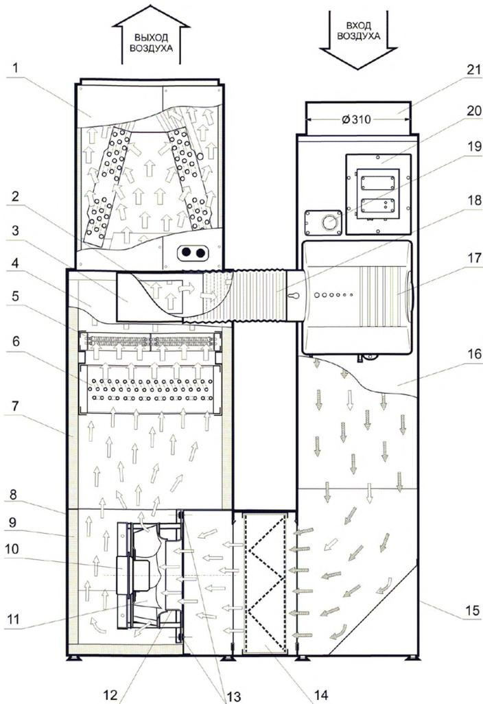
Рис. 2.2.4. б) Список оборудования агрегата воздушнонагревательного для системы воздушного отопления «АНТАРЕС-Комфорт»:
