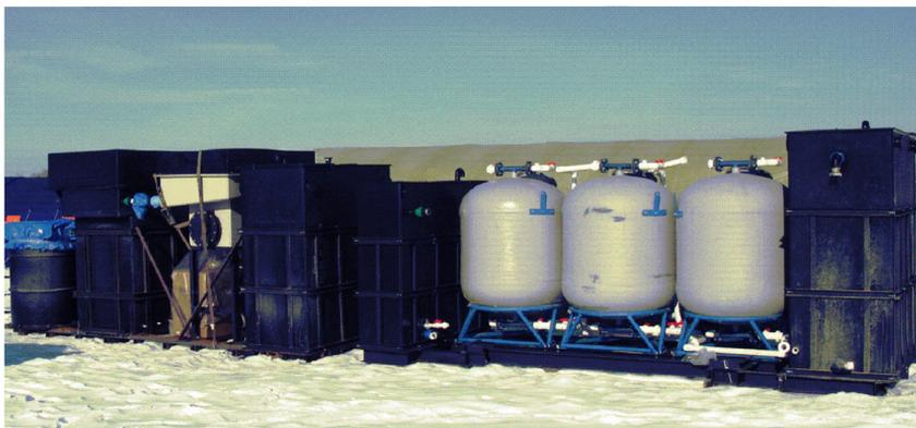
*Рисунок 2.6.1. Общий вид установки очистки технических вод и стоков ЭХО-К-3*
