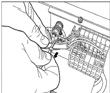
*Рисунок 2.2.11. Фиксирование внешних проводов в контактной колодке*
