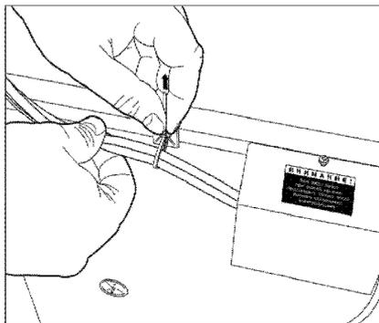
*Рисунок 2.2.12. Закрепление кабеля и провода к корпусу агрегата*
