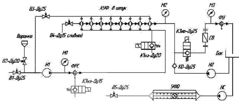
Рисунок 2.4.2. Принципиальная гидравлическая схема установки
