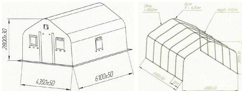
Рис. 2.1.6. Устройство палатки модульной каркасной «Арсенал-5»
