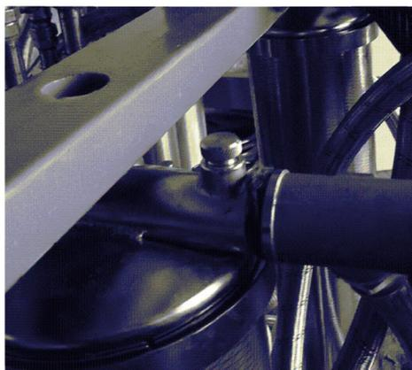
*Рис. 2.4.13. Спускной болт с круглой рифлёной головкой*
