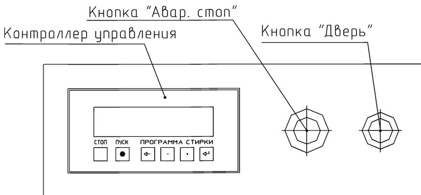
Рис. 2.5.10. Расположение органов управления контролёра машины стирально-отжимной ЛО-7
