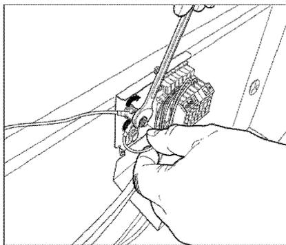
*Рисунок 2.2.10. Закрепление провода заземления в контактной колодке*
