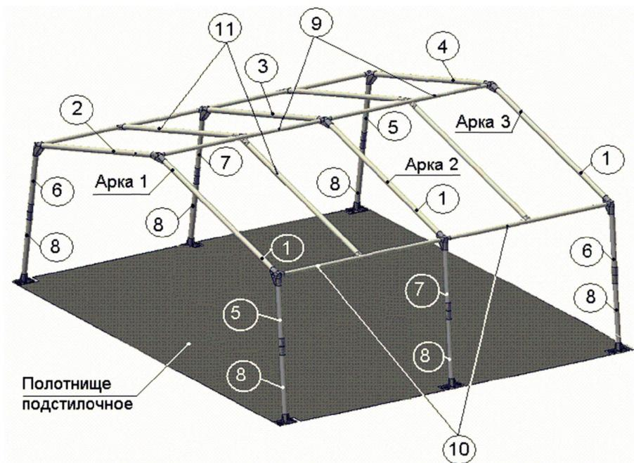
*Рис. 2.1.4. Каркас палатки типа СМ.ПКн с полотнищем подстилочным:
