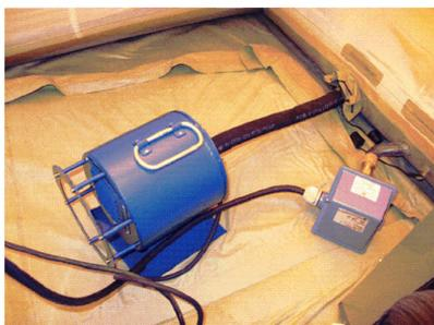
*Рисунок 2.1.9. Устройство наддува (подкачки) воздуха УН-1300*
