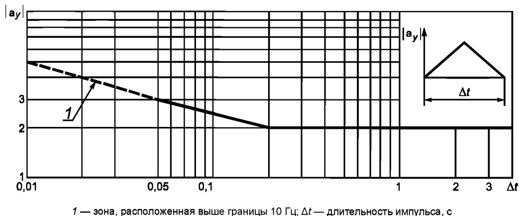
Рисунок Б.1 — Допустимое ускорение сиденья |a_y| в зависимости от длительности импульса
