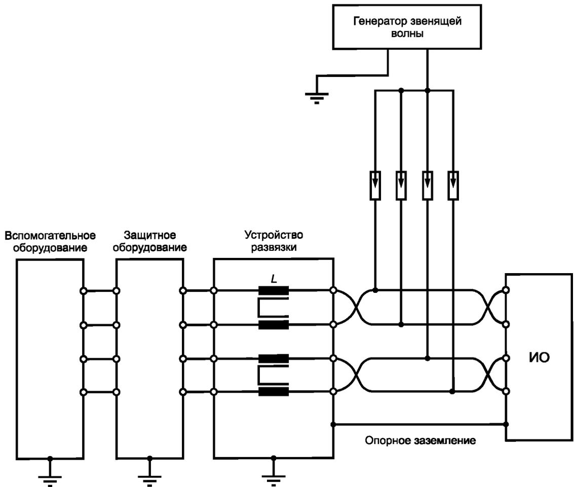
Примечание — Газовые разрядники, показанные на схеме, могут быть заменены схемой восстановления постоянной составляющей, показанной на рисунке 11.
