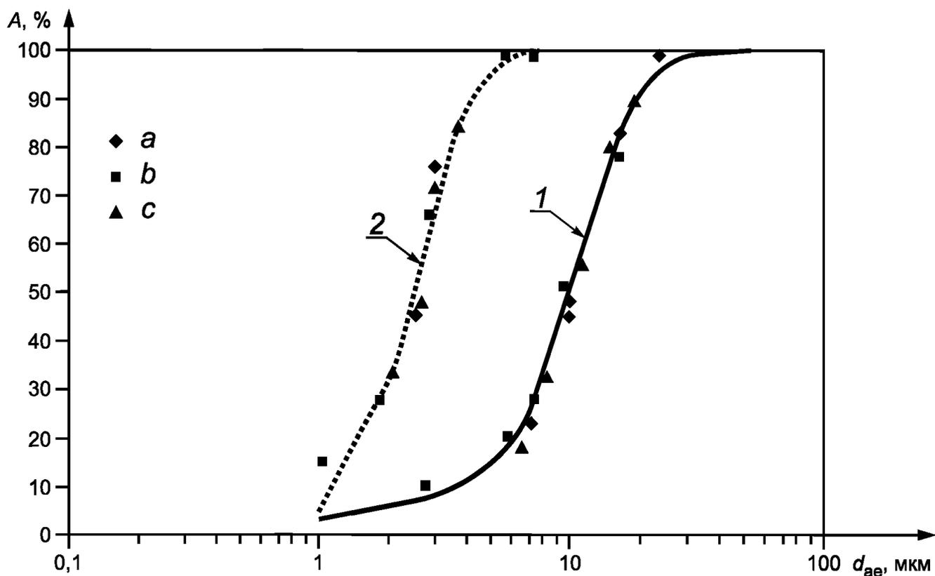
$A$  — эффективность разделения;  $d_{ae}$  — аэродинамический диаметр; 1 — норматив по торакальной фракции, ИСО 7708 [1]; 2 — норматив повышенного риска по респираторной фракции, ИСО 7708 [1];  $a$  — без колпака;  $b$  — с колпаком;  $c$  — образец
