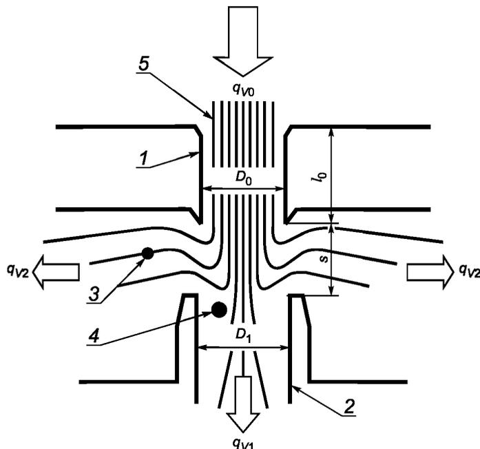
1 — сопло ускорения частиц; 2 — сопло для улавливания частиц; 3 — траектории измеряемых мелкодисперсных частиц; 4 — траектории крупных частиц; 5 — направление потока;  $D_0$  — диаметр сопла ускорения частиц;  $D_1$  — диаметр сопла для улавливания частиц;  $l_0$  — длина сопла импактора;  $s$  — расстояние между выходным отверстием сопла ускорения частиц и входным отверстием сопла для улавливания частиц;  $q_{v0}$  — общий расход;  $q_{v1}$  — побочный расход;  $q_{v2}$  — основной расход
