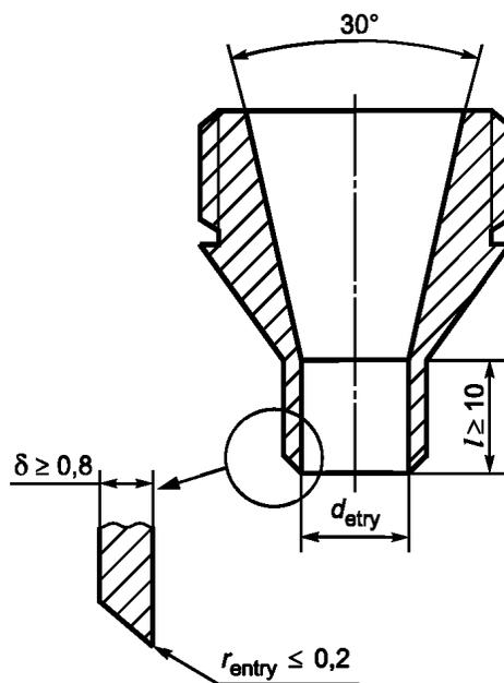
$\delta$  — толщина стенки входного сопла;  $l$  — длина с постоянным внутренним диаметром;
