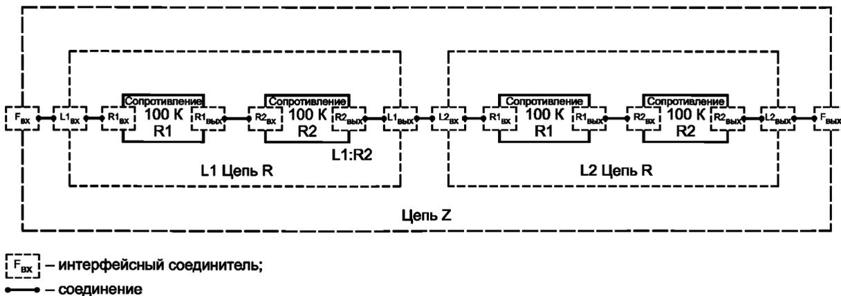
Рисунок F.3 — Иерархическая схема цепи
