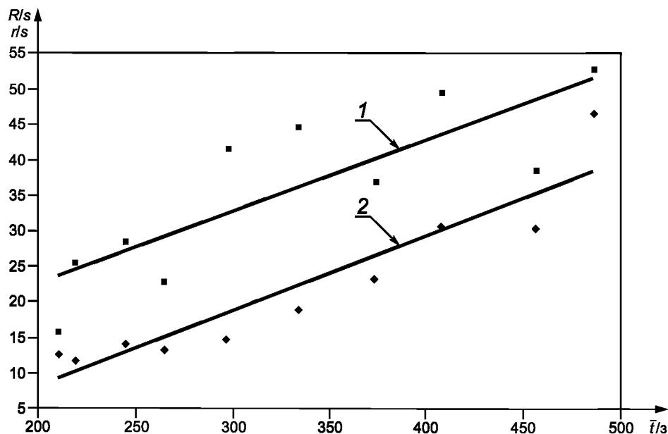
$\bar{t}$  — среднее значение FN;  $R$  — предельное значение воспроизводимости;  $r$  — предельное значение повторяемости; 1 — уравнение воспроизводимости:  $R = 0,1025\bar{t} + 2,103$ ;  $r_{tR}^2 = 0,689$ , где  $r_{tR}$  — коэффициент корреляции в уравнении воспроизводимости;
