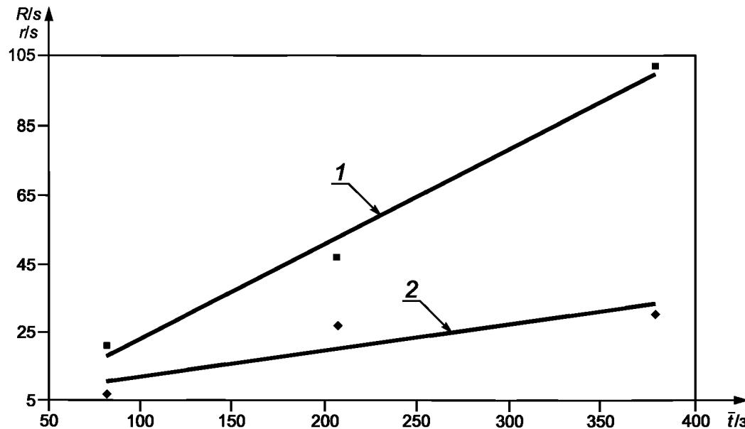
$t$  — среднее значение FN;  $R$  — предельное значение воспроизводимости;  $r$  — предельное значение повторяемости; 1 — уравнение воспроизводимости:  $R = 0,274t - 4,445$ ;  $r^2_{tR} = 0,986$ , где  $r^2_{tR}$  — коэффициент корреляции в уравнении воспроизводимости; 2 — уравнение повторяемости:  $r = 0,0752t + 4,612$ ;  $r^2_{tR} = 0,7869$ , где  $r^2_{tR}$  — коэффициент корреляции в уравнении повторяемости
