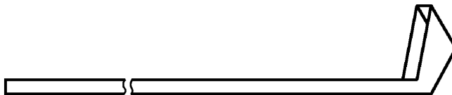
Рисунок А.6 — Пробоотборник для отбора проб из перемещаемой струи (типа «Пеликан»)
