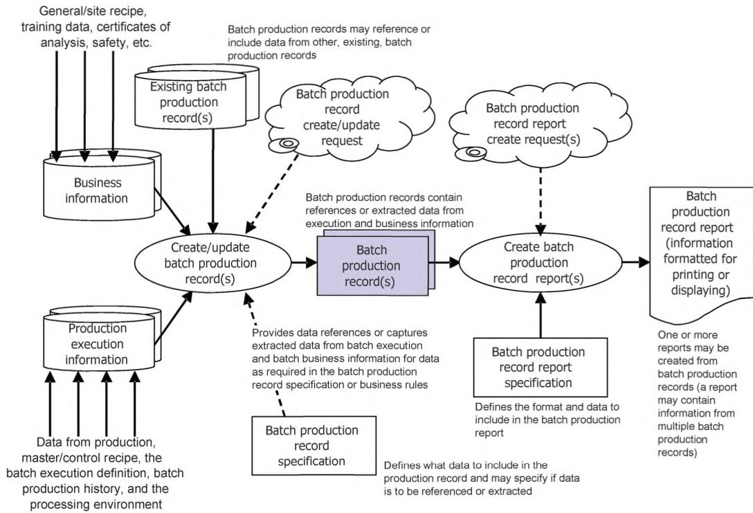
Рисунок 1 — Создание и использование данных серийного производства
