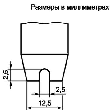
Рисунок 3 — Конец вырубного ножа с выемкой
