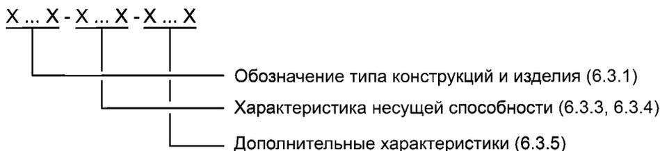
Рисунок 2 — Структура марки типовых конструкций в чертежах КМ
