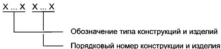
Рисунок 1 — Структура марки конструкции (изделия) в чертежах КМ
