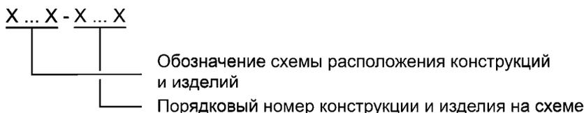
Рисунок 3 — Структура марки конструкции (изделия) в чертежах КМД
