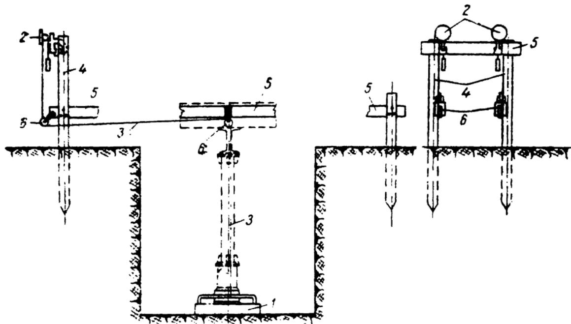
Рис. 1. Схема установки прогибомеров для измерения осадки штампа
