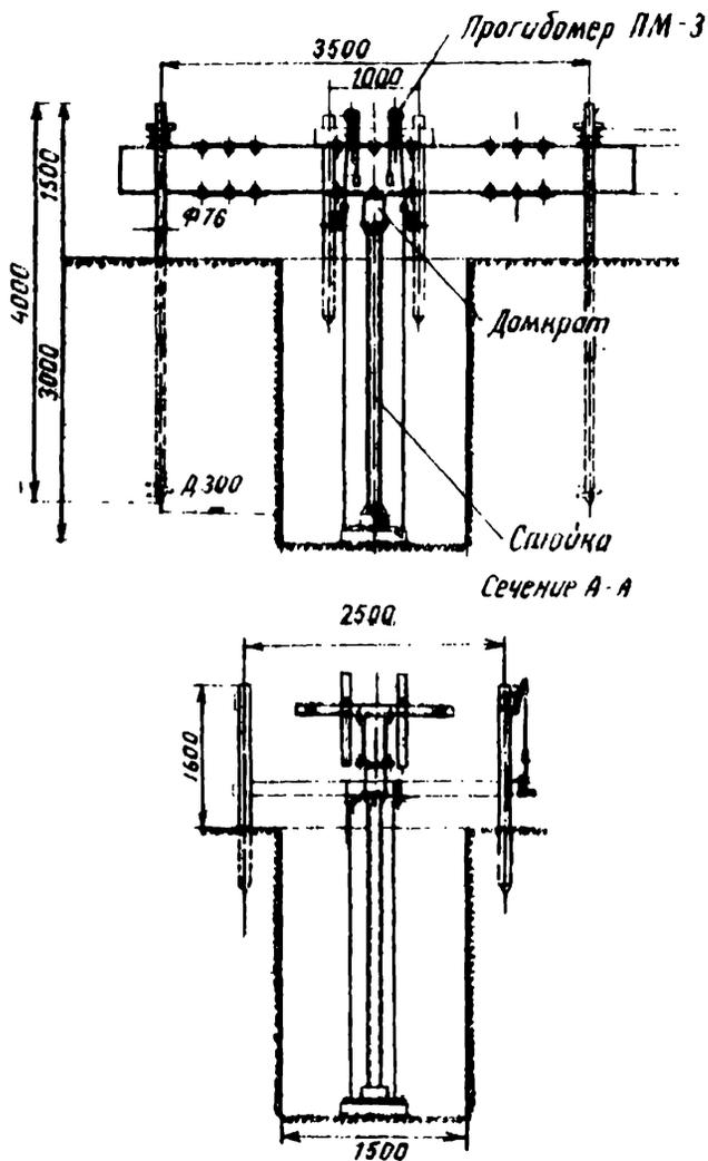
Установка с винтовыми анкерными сваями для
