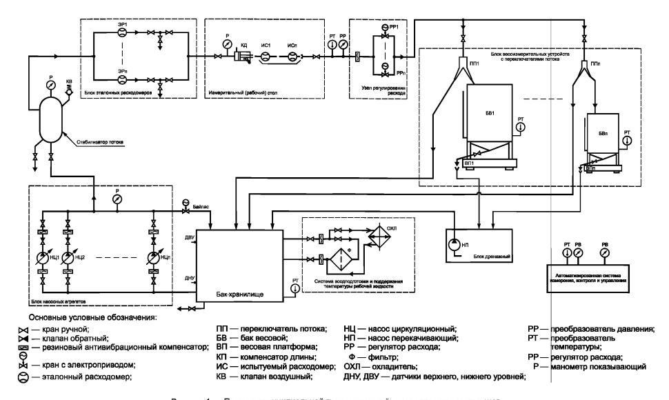
Рисунок 1 — Пример принципиальной гидравлической схемы вторичных эталонов
