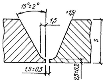
§ В17-5-9. Стыковое соединение с криволинейным скосом кромок, одностороннее (С29). Сварка по заваренному корню
