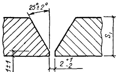
§ В17-5-22. Стыковое соединение со скосом кромок, одностороннее (С17)
