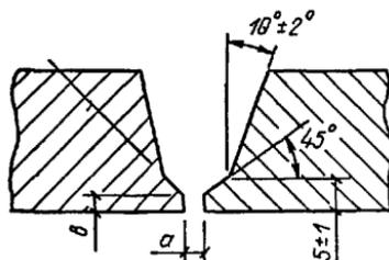
§ В17-5-4. Стыковое соединение с ломаным скосом кромок, одностороннее (ТР-66). Сварка по заваренному корню
