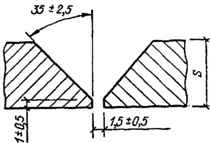
§ В17-5-15. Стыковое соединение со скосом кромок, одностороннее (С24)
