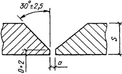
§ В17-5-10. Стыковое соединение со скосом кромок, одностороннее (С17)
