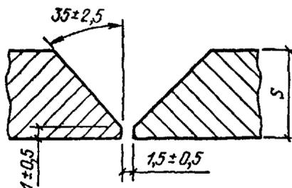
§ В17-5-18. Стыковое соединение со скосом кромок, одностороннее (С24)
