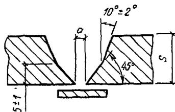
§ В17-5-3. Стыковое соединение с ломаным скосом кромок, одностороннее на остающейся цилиндрической подкладке (ТР-6)
