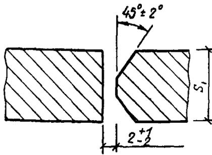
§ В17-5-25. Стыковое соединение с двумя симметричными скосами одной кромки, двустороннее (С15)
