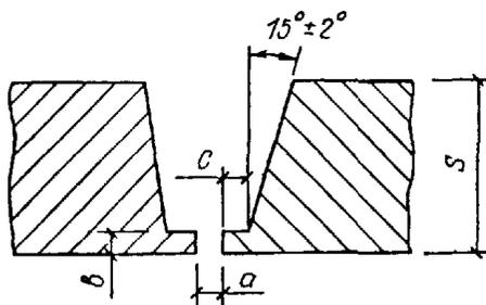
§ В17-5-5. Стыковое соединение с криволинейным скосом кромок (под ус) (ТР-7а). Сварка по заваренному корню
