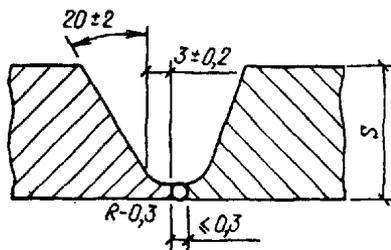
§ В17-5-12. Стыковое соединение с криволинейным скосом кромок, одностороннее (С25, С42,). Сварка по заваренному корню
