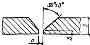
§ В17-5-2. Стыковое соединение со скосом кромок, одностороннее (ТР-2). Сварка по заваренному корню
