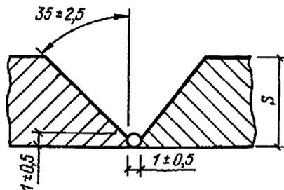
§ В17-5-11. Стыковое соединение со скосом кромок, одностороннее (С 24). Сварка по заваренному корню
