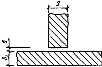
§ В17-5-27. Тавровое соединение без скоса кромок, одностороннее (Т-1)
