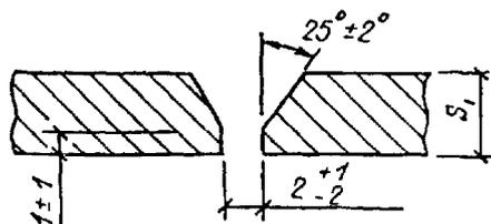
§ В17-5-30. Стыковое соединение со скосом кромок, одностороннее (С21)
