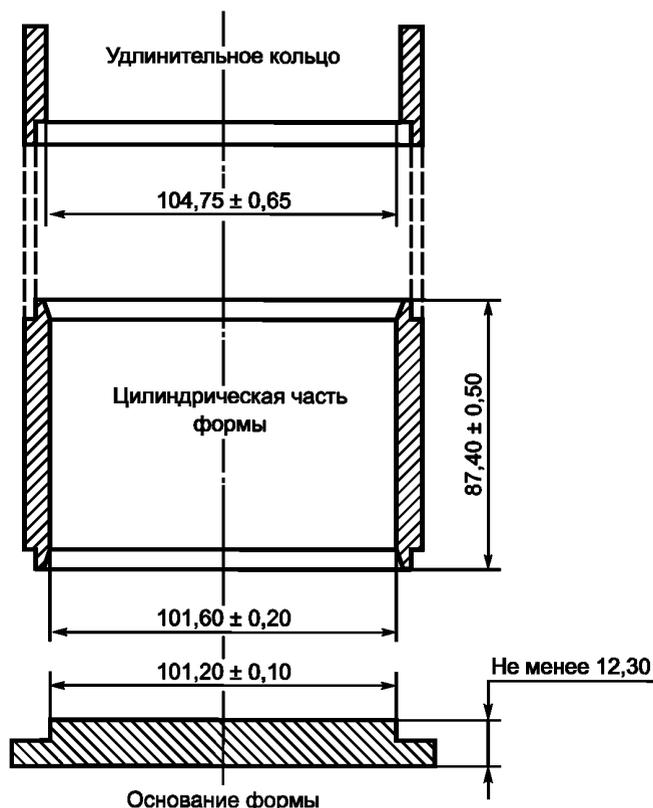
Рисунок 1 — Сборная форма для уплотнения образцов
