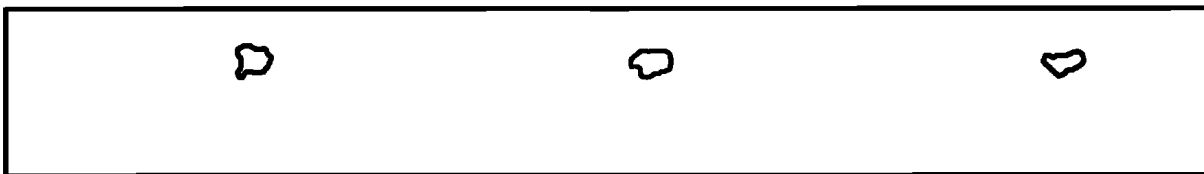
c — пример 3: три дефекта размером 4,0 мм
