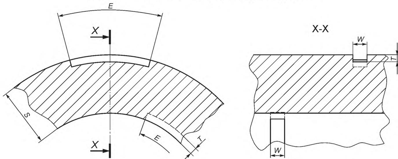
Примечание —  $T \leq (5 \pm 0,75) \% S$ , но  $0,2 \text{ мм} \leq T \leq 1 \text{ мм}$ ;  $W \leq 2T$ , но, если невозможно, то  $W \leq 1 \text{ мм}$ ;  $E \leq 50 \text{ мм}$ .
