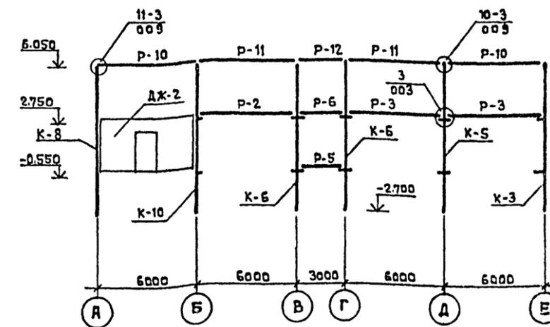
МОНТАЖНЫЕ СХЕМЫ ДИАФРАГМ ЖЕСТКОСТИ
