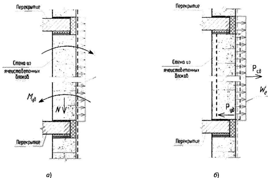
Рис. 3.13. Расчетные схемы поэтажно опертой стены
