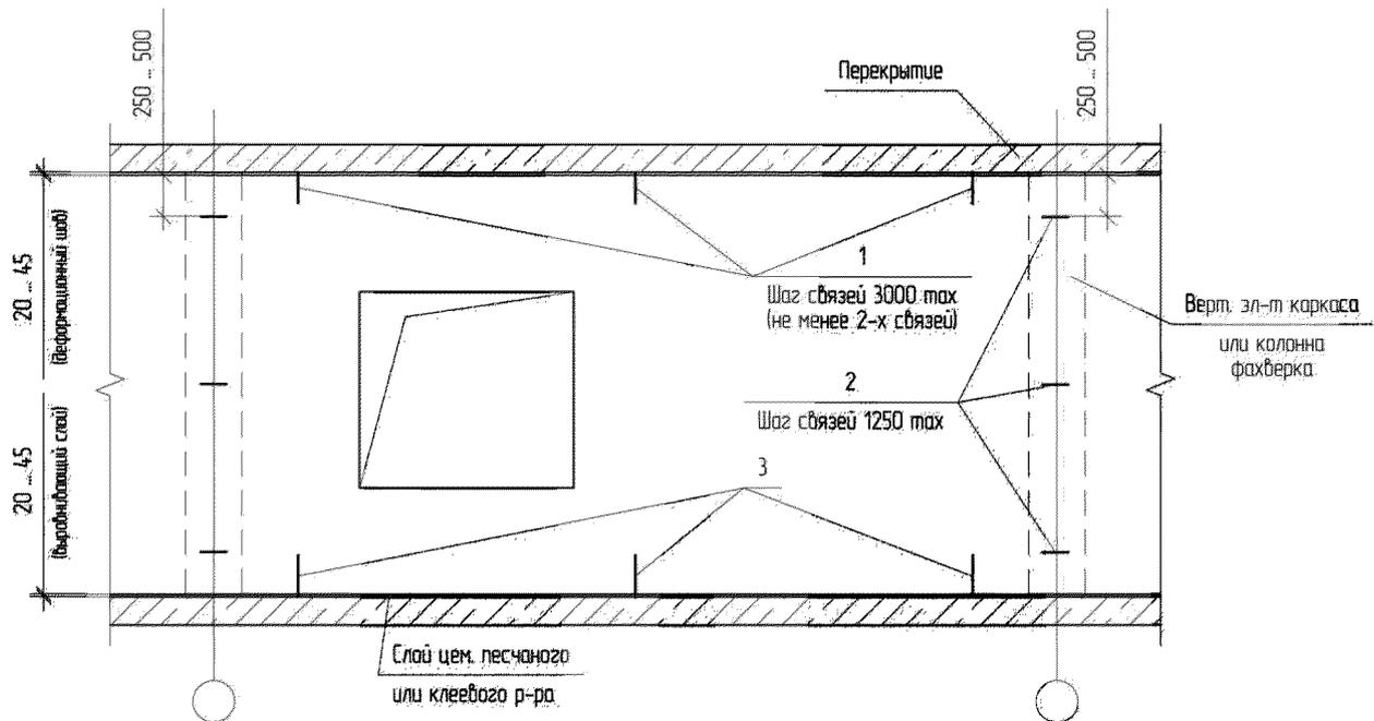
Рис. 4.5. Схема расположения связи (крепления) наружных и внутренних стен
