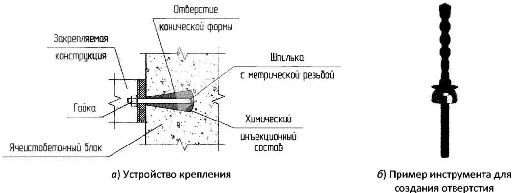
**Рис. Б.1. Химический анкер с анкерной формой**
