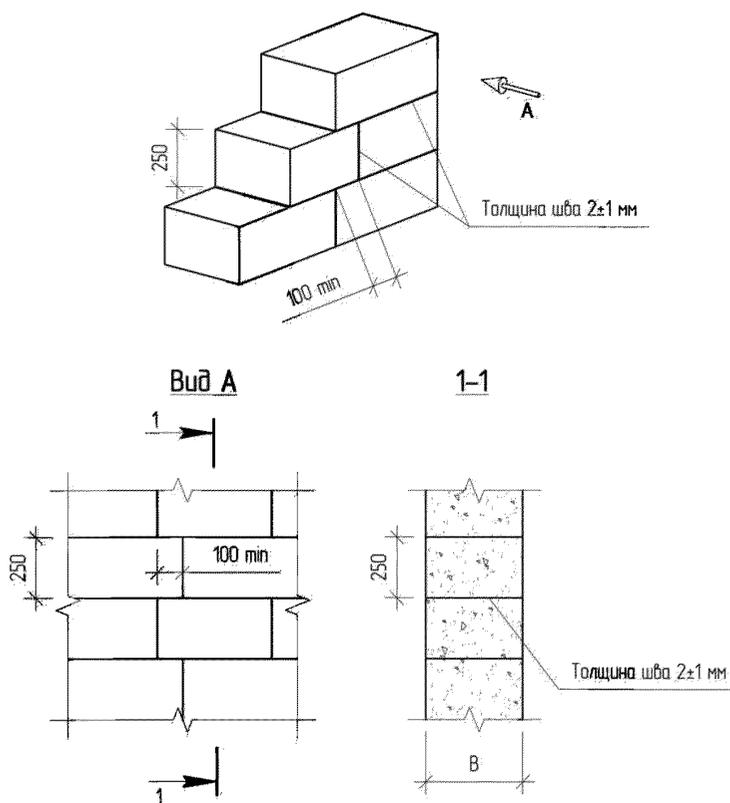
Рис. 3.1. Схема кладки стен толщиной в один блок
