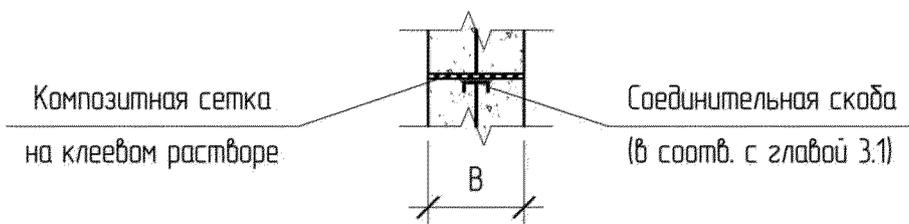
б) При кладке толщиной в два неперевязанных блока
