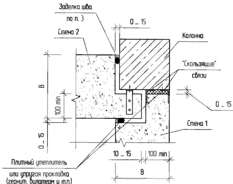
**При выступе стены 2 за колонну до 100 мм включительно**
