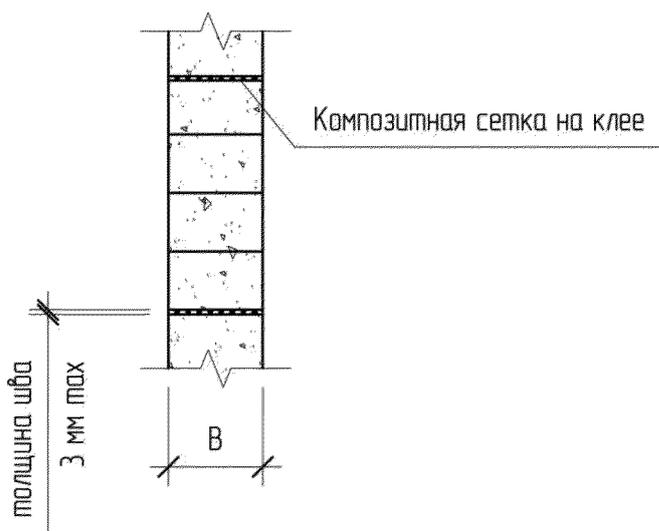
а) При кладке толщиной в один блок или кладке в два блока с «плашковой» перевязкой
