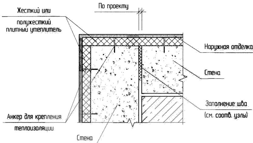
**Отделка стен в зонах стыка с вертикальными элементами каркаса**
