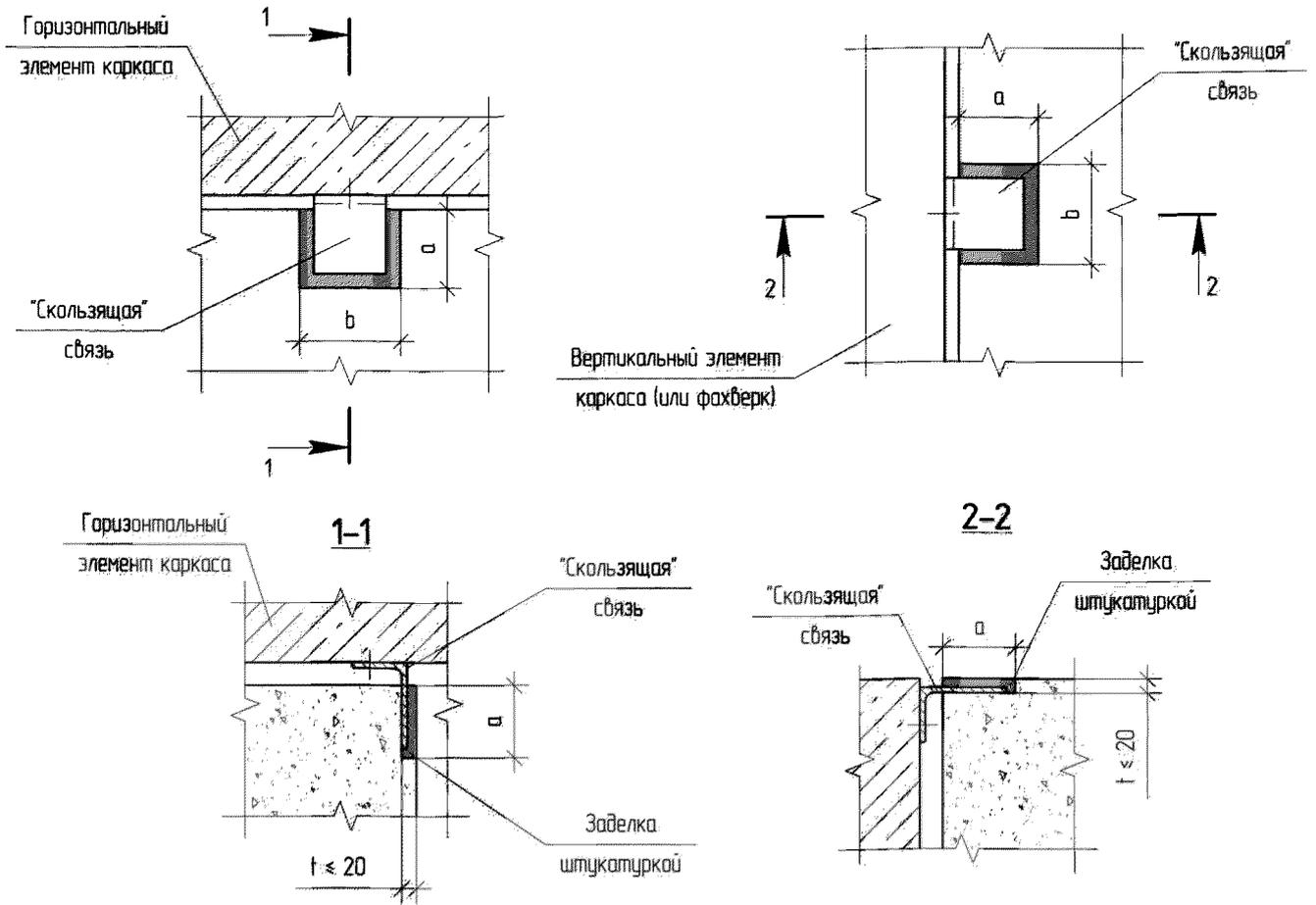
Рис. 4.3. Схема установки «скользяще» детали «в пота»
