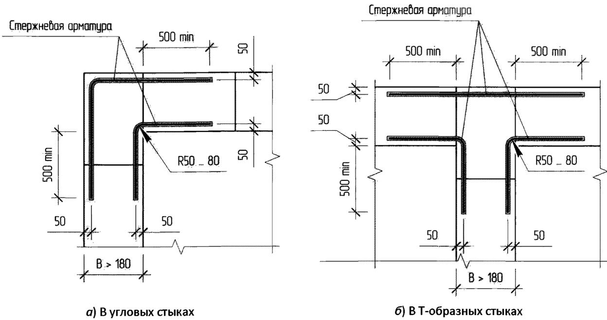
Рис. 3.9. Пример раскладки арматурных стержне на пересечении стен (при толщинах стен более 180 мм)
