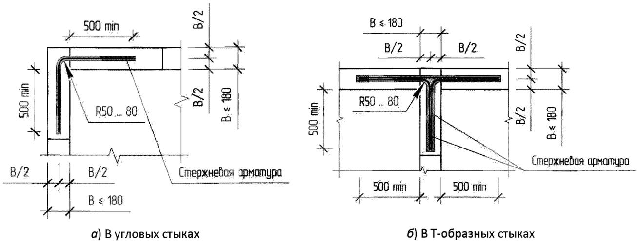
Рис. 3.10. Пример раскладки арматурных стержне на пересечении стен (при толщинах стен до 180 мм)
