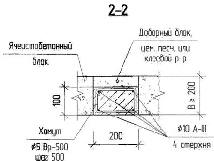
Узел XIV. Устройство парапета плоской кровли
