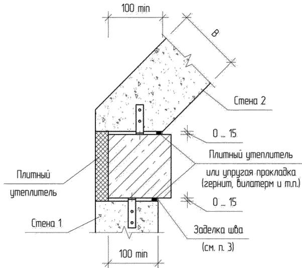
Узел III. Крепление стен к угловым колоннам
