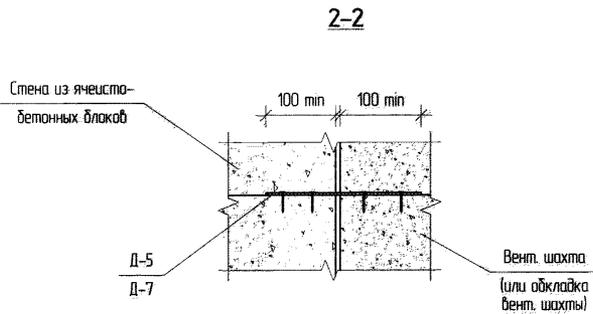
Вариант 2. Пример устройства вентиляционной шахты со сборным каналом и двумя спутниками с использованием ячеистобетонных блоков
