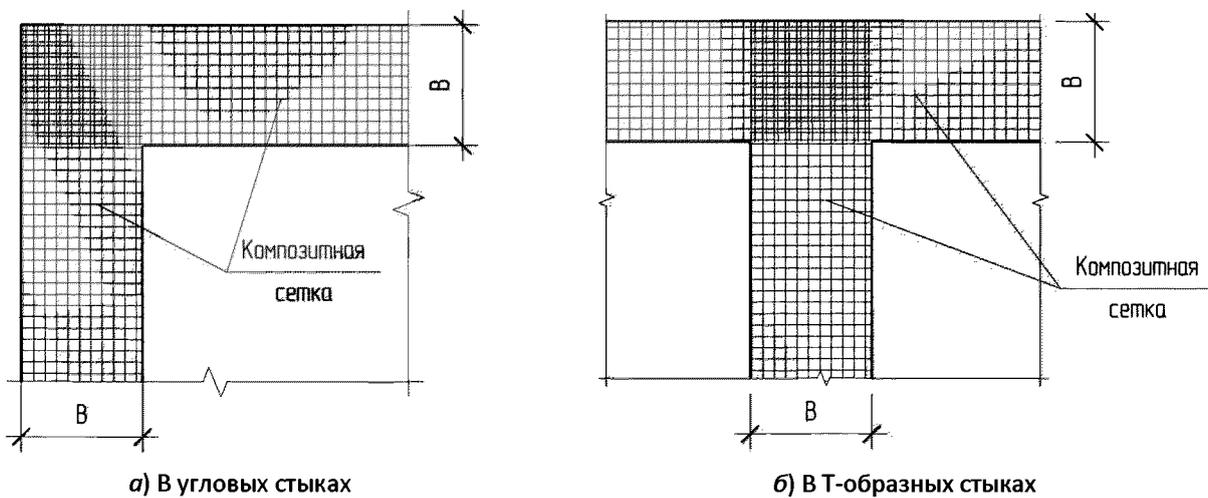
Рис. 3.11. Пример раскладки арматурных сеток на пересечении стен
