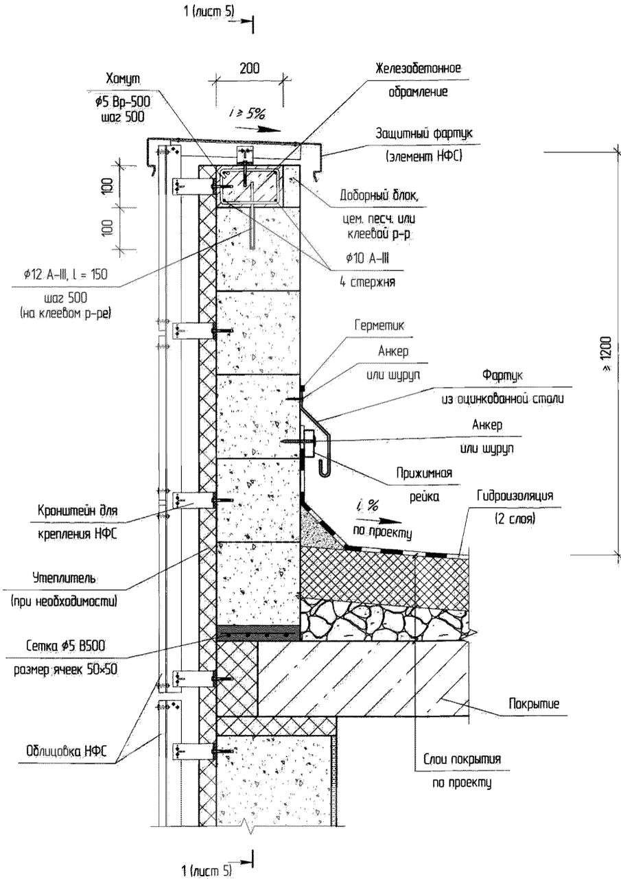
Вариант 3. Устройство парапета эксплуатируемой кровли
