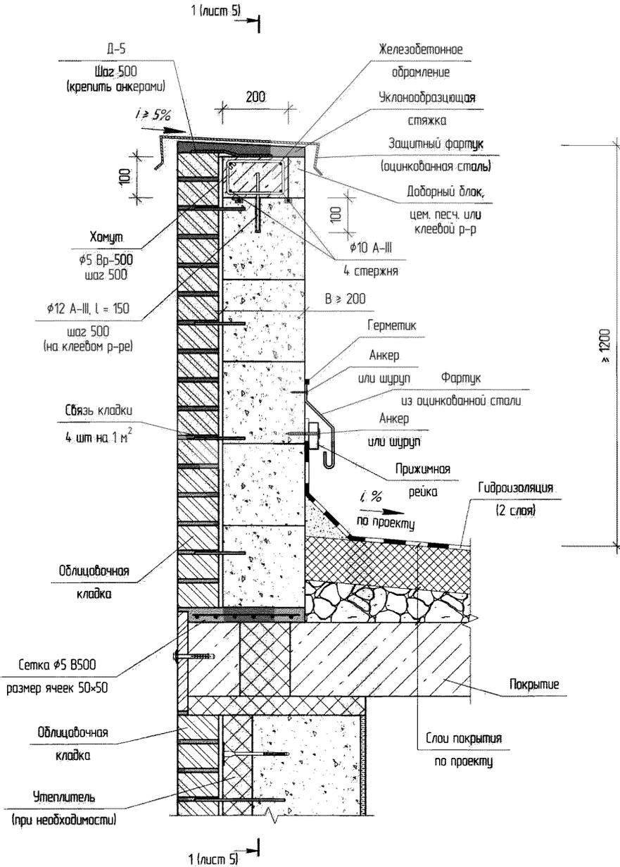
Узел XIV. Устройство парапета плоской кровли
