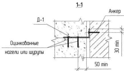
Узел IV. Крепление стен в зонах деформационных швов и при одностороннем примыкании к колоннам
