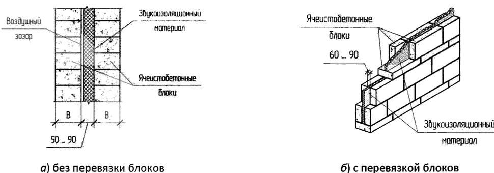
Рис. 3.5. Примеры устройства стен со звукоизоляционной прослойкой
