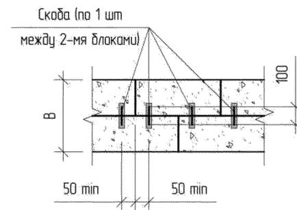
Рис. 3.3. Схема кладки стен толщиной в два одинаковых по толщине блока
