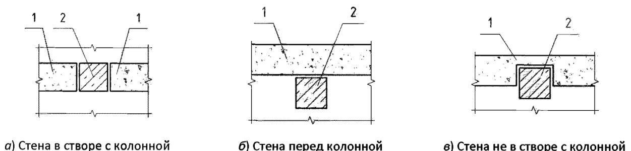
Рис. 4.6. Схемы расположения стен по отношению к вертикальным конструкциям несущего каркаса здания
