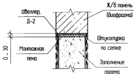
Узел X. Заполнение проемов в диафрагмах
