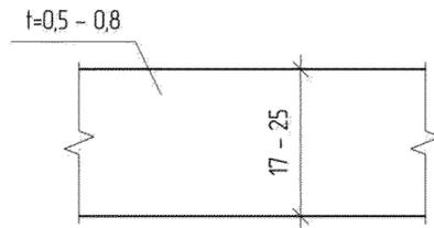
Из стальной перфорированной оцинкованной полосы:
