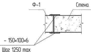
При помощи пластины и уголка (или детали Д-3)
