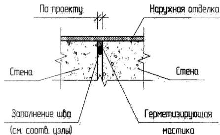
**Отделка стен в зонах стыка с вертикальными элементами каркаса**
