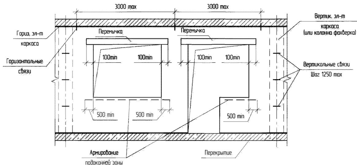
Рис. 4.8. Схема устройства проемов на примере наружной стены
