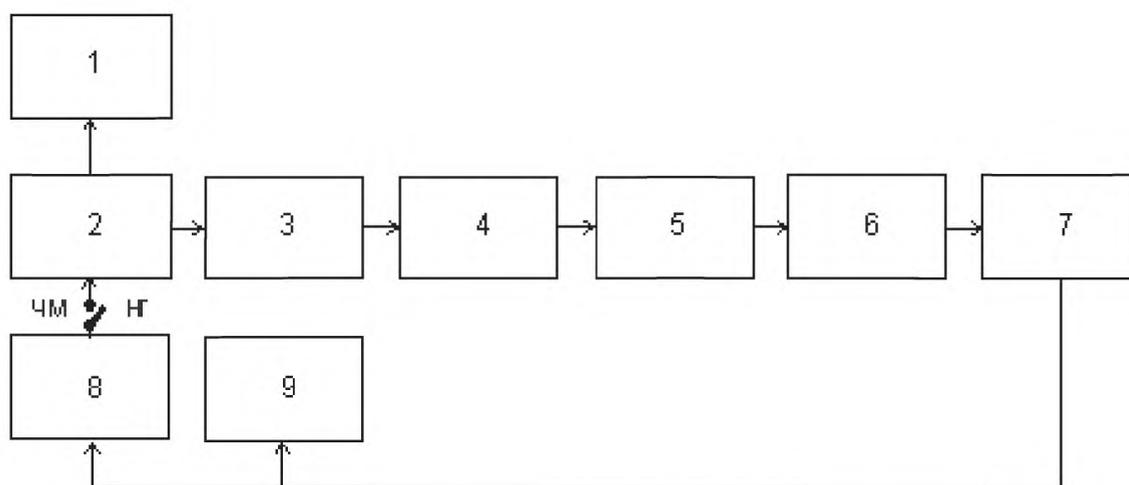
1 – частотомер; 2 – генератор СВЧ; 3, 6 – развязывающий вентиль;
