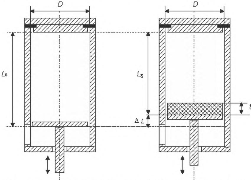
Рисунок А.2 – Схематическое изображение объемного резонатора с колебанием  $H_{01p}$  для измерений при фиксированной резонансной частоте
