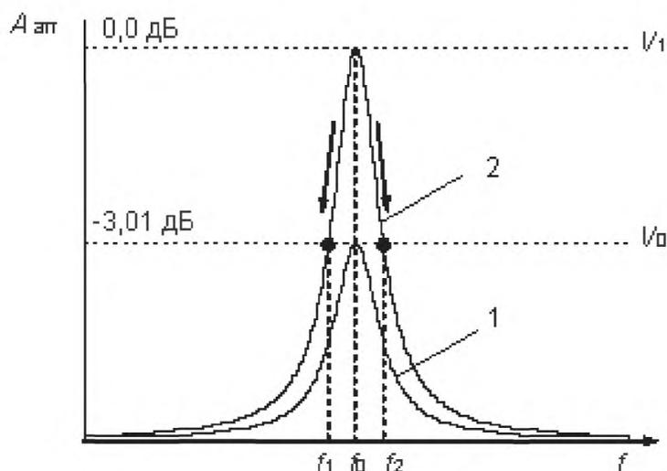
1 -резонансная кривая при ослаблении измерительного аттенюатора -3,01 дБ;
