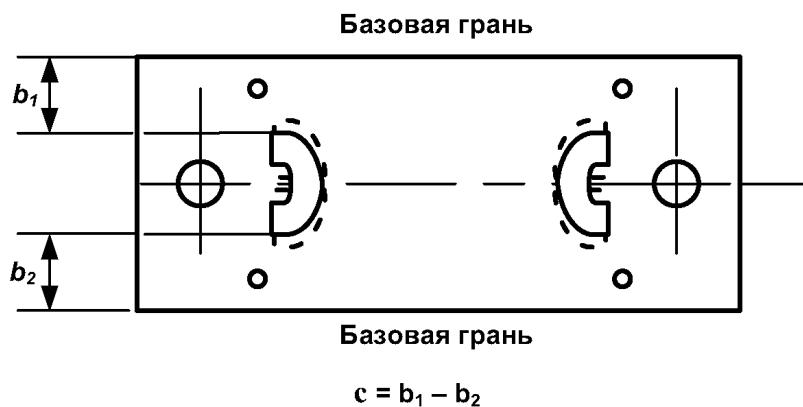
«с» — смещение; «Ч» — размер, указанный на чертеже; «d» — диаметр отверстия;
