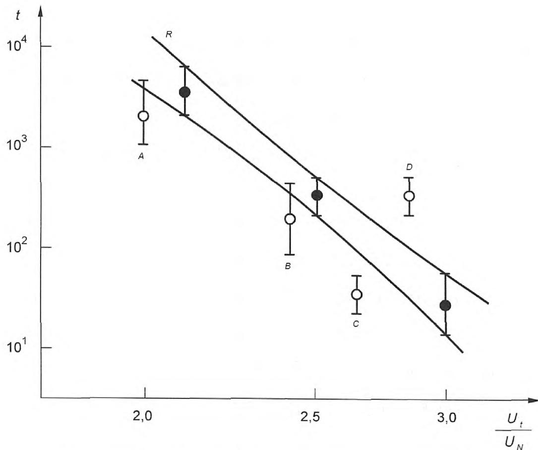
R — данные старения эталонной системы изоляции (R) с демонстрацией 90 % доверительного интервала;
