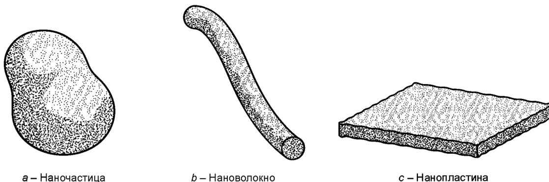
Рисунок 1 — Схематические изображения некоторых форм наночастиц
