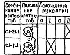
Диаграмма замыкания контактов датчика температуры „ЗК“
