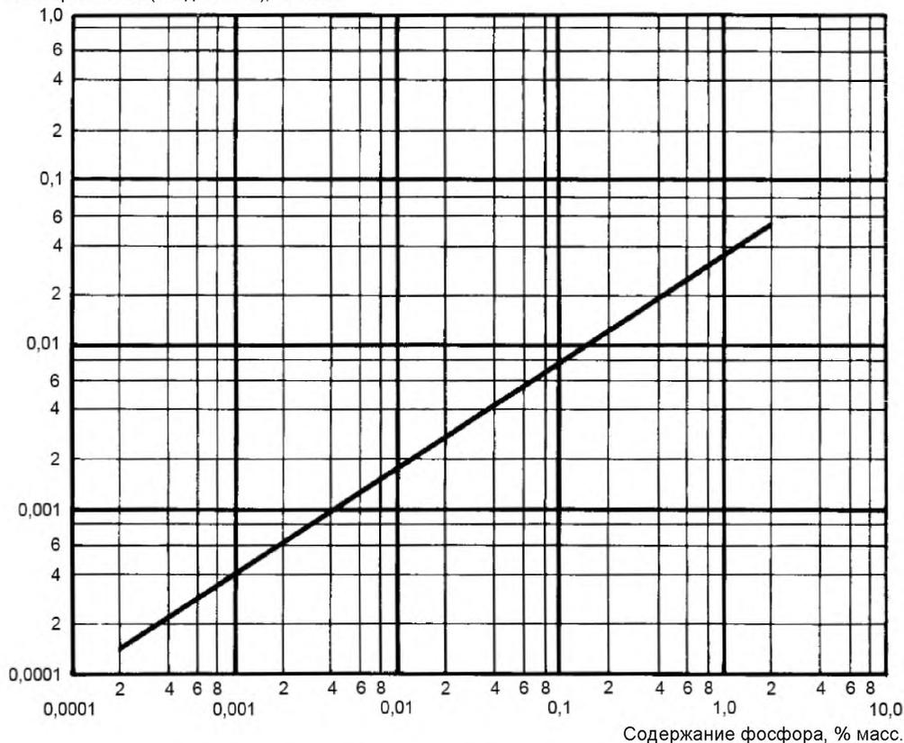
Рисунок 1 – Повторяемость (сходимость) результатов испытаний, полученных фотометрическим методом
