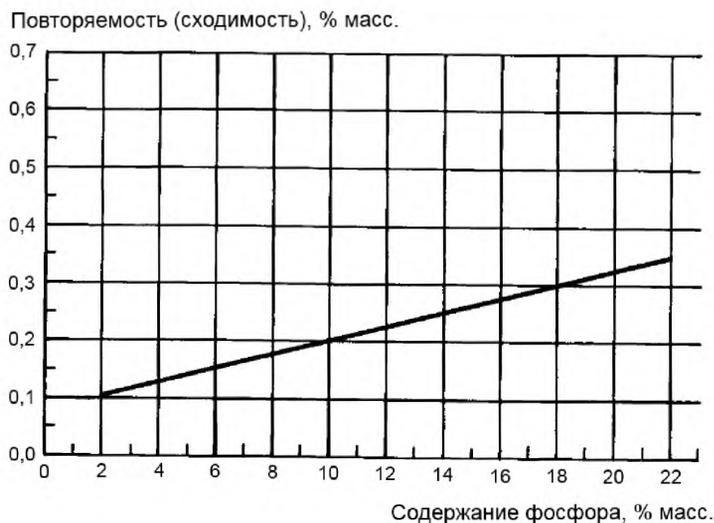
Рисунок 2 – Повторяемость (сходимость) результатов испытаний, полученных гравиметрическим методом
