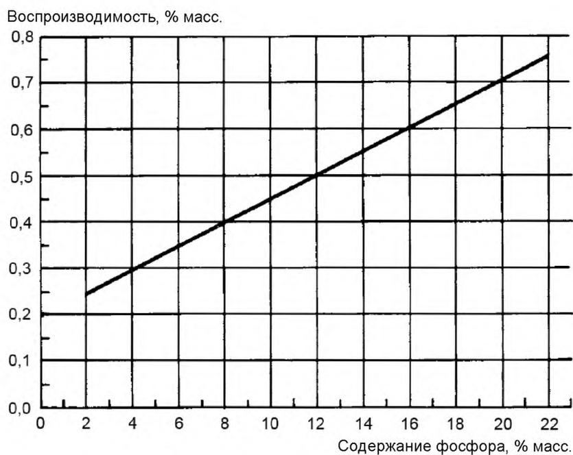
Рисунок 4 – Воспроизводимость результатов испытаний, полученных гравиметрическим методом
