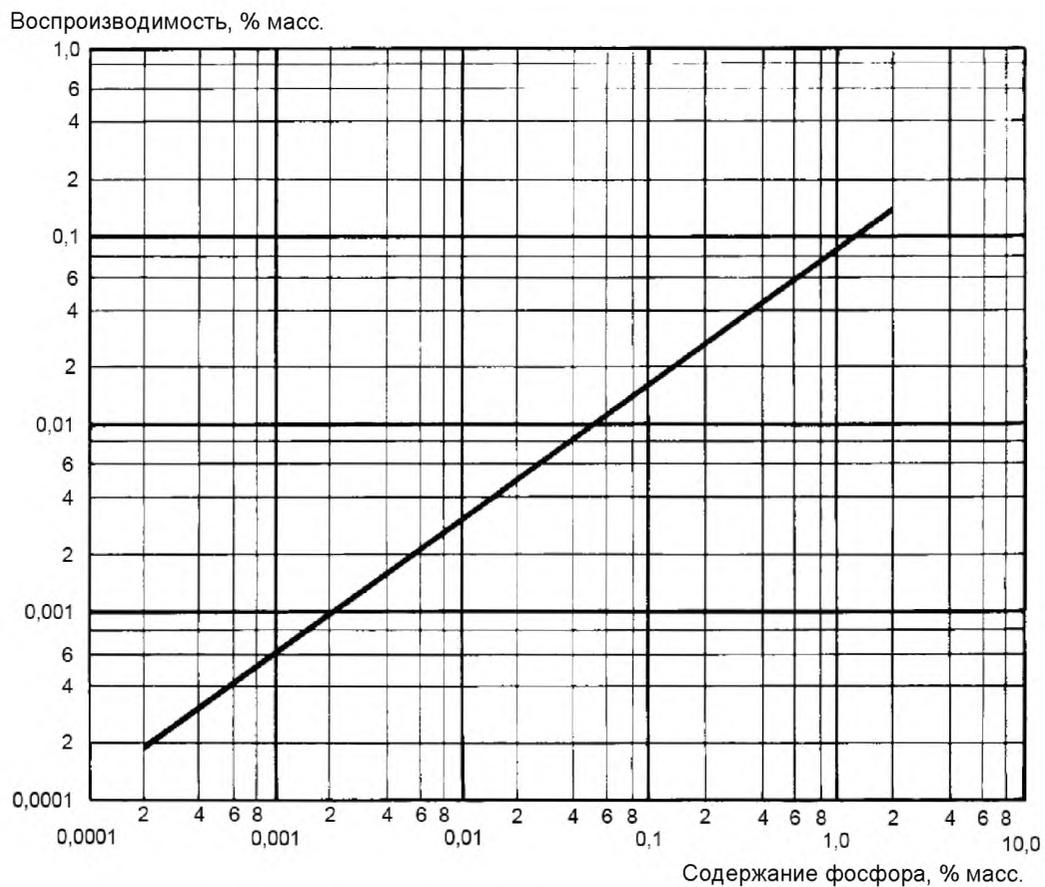
Рисунок 3 – Воспроизводимость результатов испытаний, полученных фотометрическим методом
