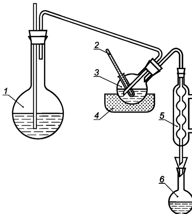
1 — парообразователь — колба К-1-1000(2000)-29/32 (34/35, 45/40) ТС по ГОСТ 25336; 2 — термометр для измерения температуры до 150 °С с минимальной ценой деления 1 °С; 3 — реакционная круглодонная короткогорлая колба вместимостью 250 см<sup>3</sup> из термостойкого стекла или кварца с карманом для термометра; 4 — колбонагреватель, соединенный с реле; 5 — шариковый холодильник; 6 — приемник для конденсата — колба мерная 2(2а)—250—2 по ГОСТ 1770
