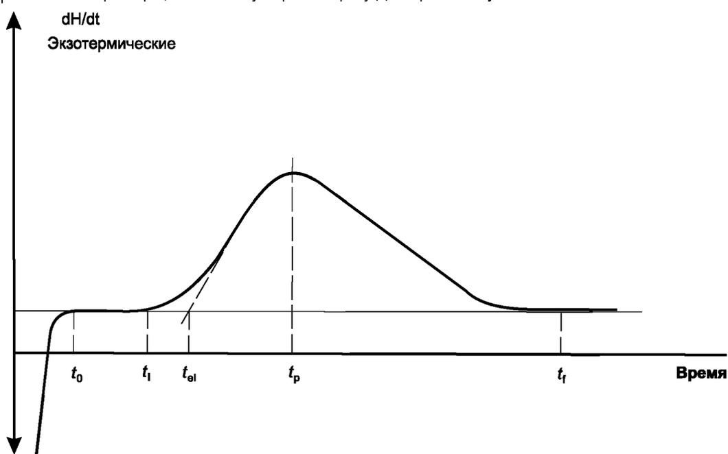
Рисунок ДБ.2 – ДСК кривая с экзотермическим пиком (изотермический метод)
