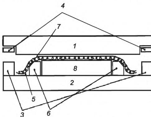
1 – верхняя пластина; 2 – опорная пластина; 3 – направляющие вставки; 4 – вставки заданной толщины; 5 – впитывающий материал; 6 – металлические бруски; 7 – мембранное полотно; 8 – уложенные слои препрега
