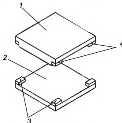
1 – верхняя пластина; 2 – опорная пластина; 3 – направляющие вставки;
