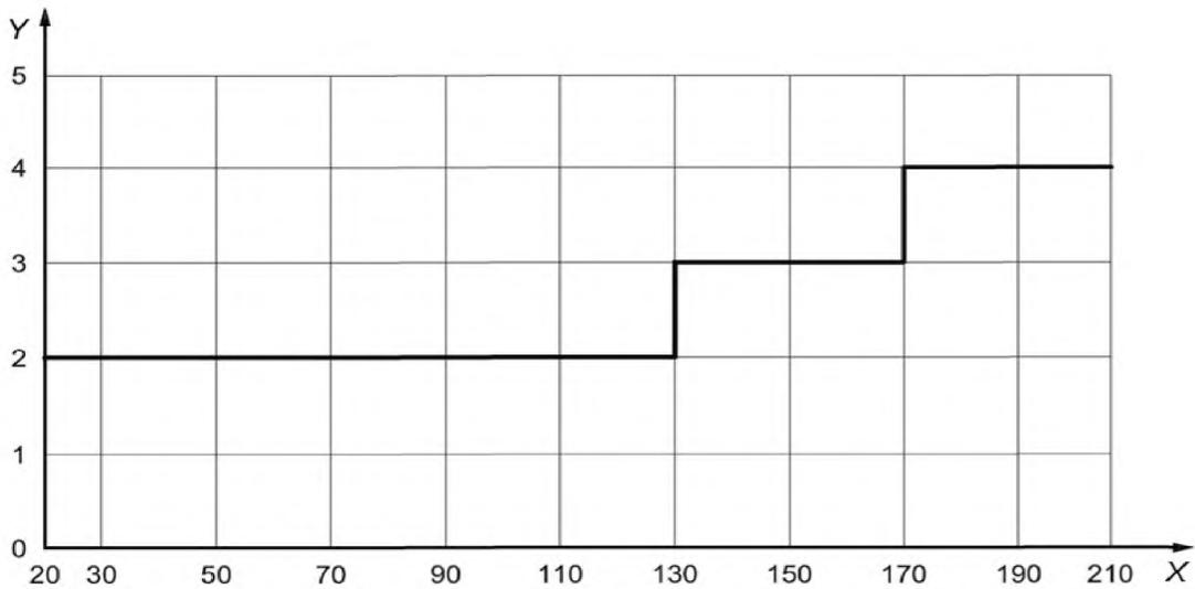
X – температура отверждения, °C; Y – допустимое отклонение температуры, °C
