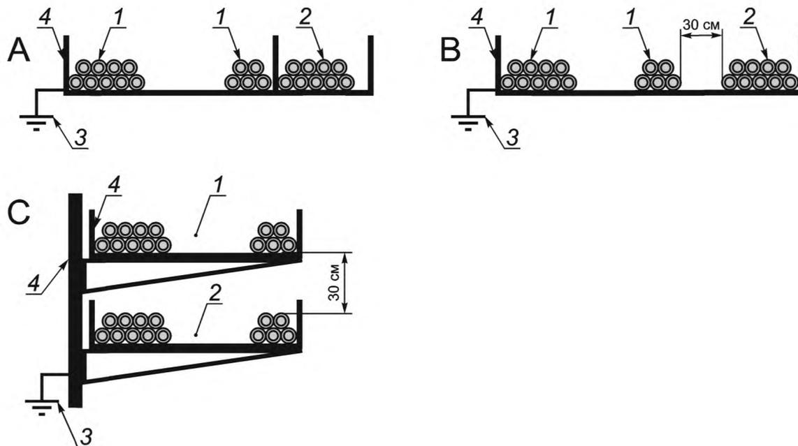
1 — сигнальный кабель; 2 — низковольтный кабель электропитания; 3 — соединение с землей; 4 — стальная конструкция, выравнивающая потенциалы; А — кабели разных категорий отделяют металлическими перегородками; В — кабели разных категорий отделяют за счет расстояния между ними; С — кабели разных категорий отделяют, используя различные металлические кабельные каналы, или путем укладки на расстоянии, если конструкция не металлическая
