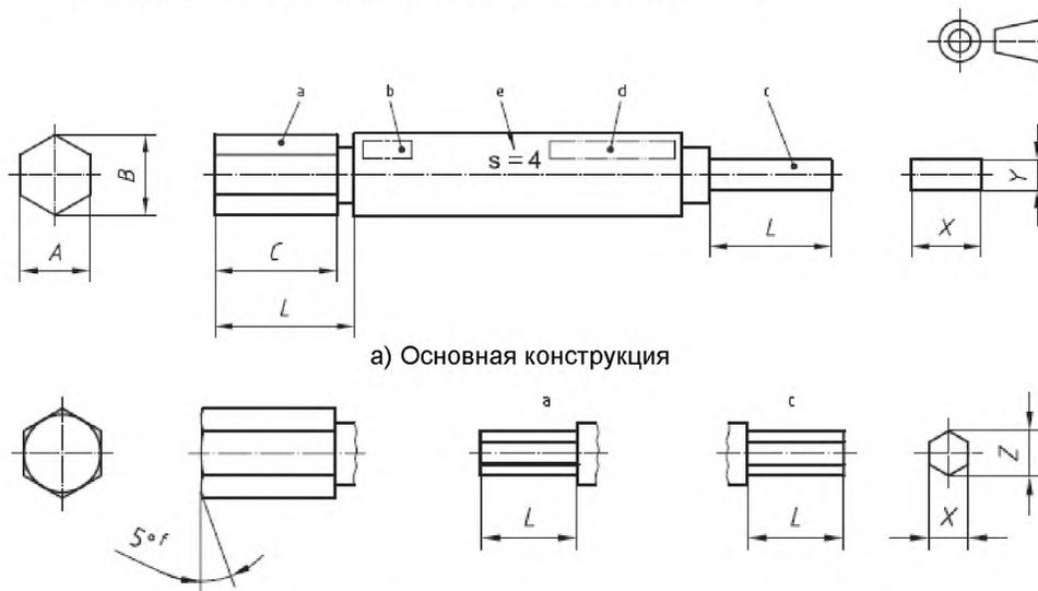
б) Дополнения к конструкции GO калибра или NOT GO калибра для малых размеров
