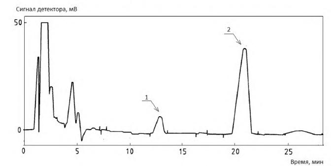
1 — пик нитрита (время удерживания — 12,63 мин), соответствующий его содержанию в пробе 38,9 мг/кг (млн $^{-1}$ ); 2 — пик нитрата (время удерживания — 20,73 мин), соответствующий его содержанию в пробе 289,6 мг/кг (млн $^{-1}$ )
