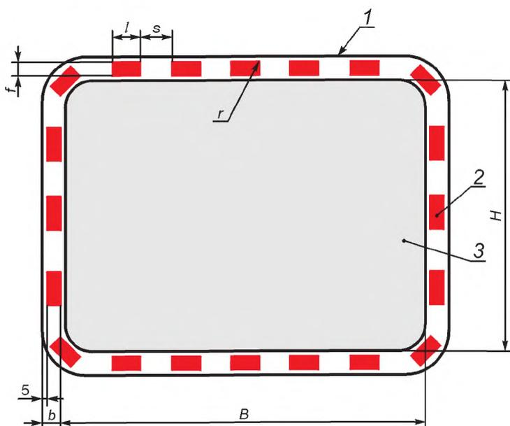
1 — окантовка; 2 — световозвращающий элемент окантовки; 3 — отражатель зеркала
