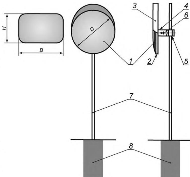
1 — отражатель; 2 — корпус зеркала;
