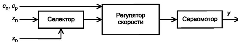
Рисунок 15 — Управление мощностью через регулятор скорости
