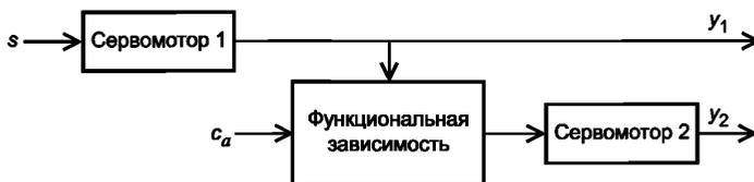
$s$  — выходной сигнал электронного регулятора;  $y_1$  — выходной сигнал сервомотора 1;  $y_2$  — выходной сигнал сервомотора 2;  $c_a$  — входной сигнал для определения функциональной зависимости
