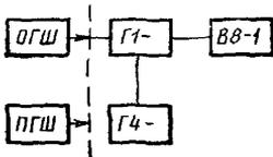
Рис. 1. Структурная схема установки для поверки ГШ с использованием приборов вида Г1: ОГШ — образцовый ГШ; ПГШ — поверяемый ГШ
