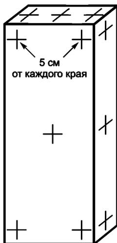
Рисунок 3 — Распределение воздействий при испытании
