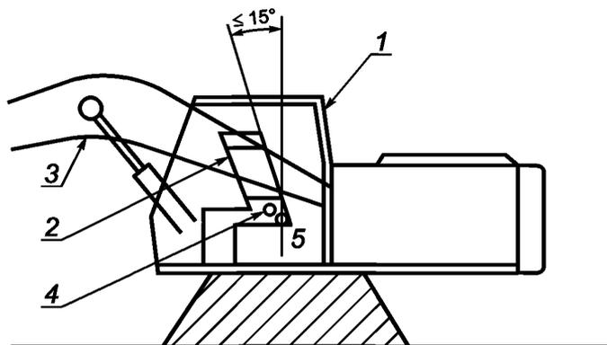
1 — ROPS; 2 — DLV; 3 — жесткие части машины; 4 — SIP; 5 — LA
