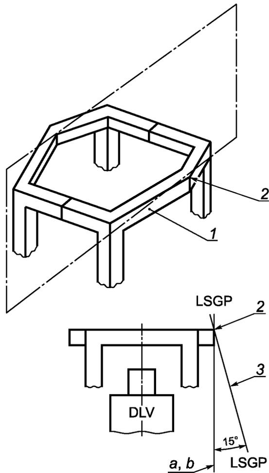
1 — верхний элемент ROPS, к которому прикладывают боковую нагрузку; 2 — наиболее удаленная точка в конструкции ROPS (1); 3 — боковая имитируемая наземная плоскость (LSGP);  $a$  — вертикальная линия, проходящая через точку (2);  $b$  — вертикальная плоскость, параллельная продольной оси машины, проходящая через линию  $a$
