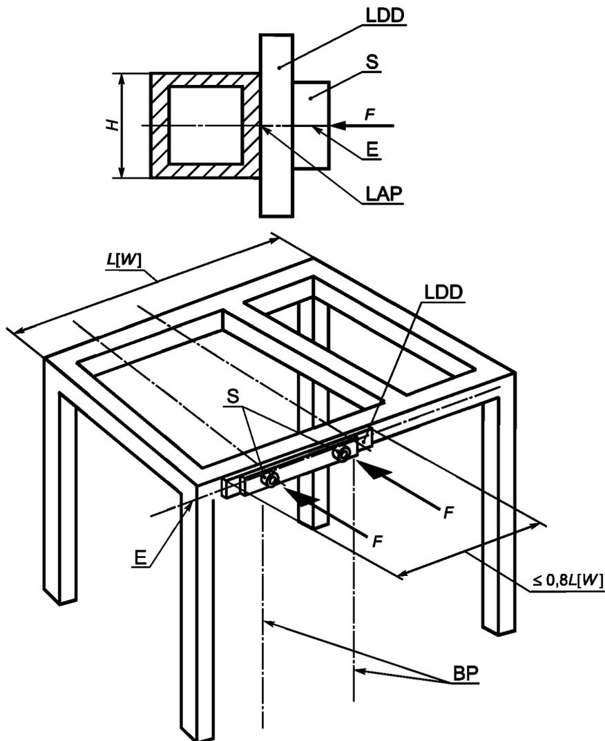
BP — граничные плоскости DLV; E — горизонтальная осевая линия верхнего конструктивного элемента ROPS; F — сила нагрузки; LAP — точка приложения нагрузки; LDD — устройство распределения нагрузки; S — соединительная муфта;  $L[W]$  — длина [ширина] ROPS
