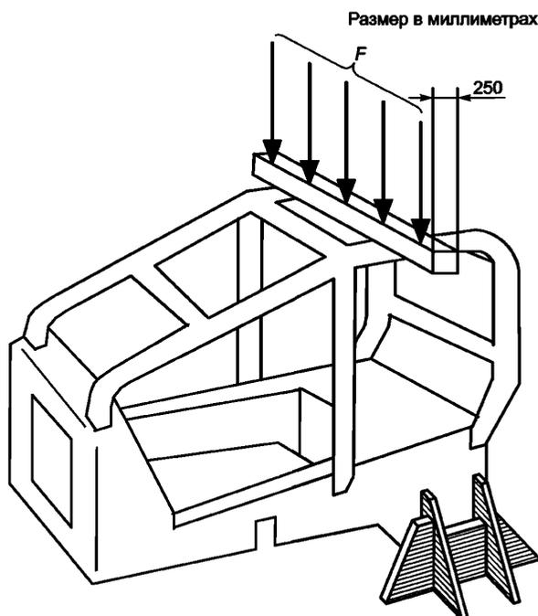
Рисунок 7 — Вертикальное нагружение
