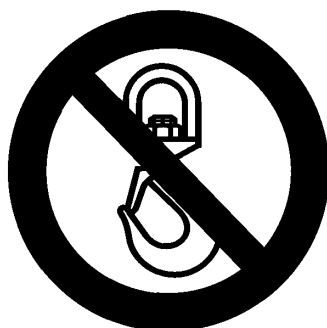
Рисунок 5 — Знак безопасности «Работа с крюком запрещена»
