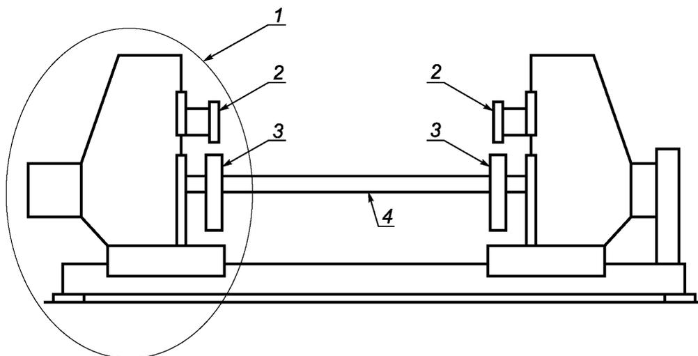
1 — половина станка; 2 — верхние прижимные балки; 3 — направляющие балки цепи; 4 — поперечный приводной вал подачи
