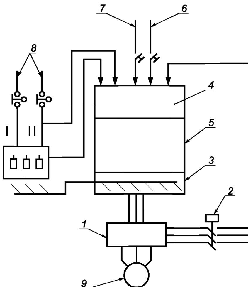
1 — регулятор привода; 2 — контактор (выключатель); 3 — выходной уровень программируемой электронной системы; 4 — входной уровень программируемой электронной системы; 5 — программируемая электронная система (ПЭС); 6 — остановка; 7 — пуск; 8 — блокируемое ограждение; 9 — электродвигатель
