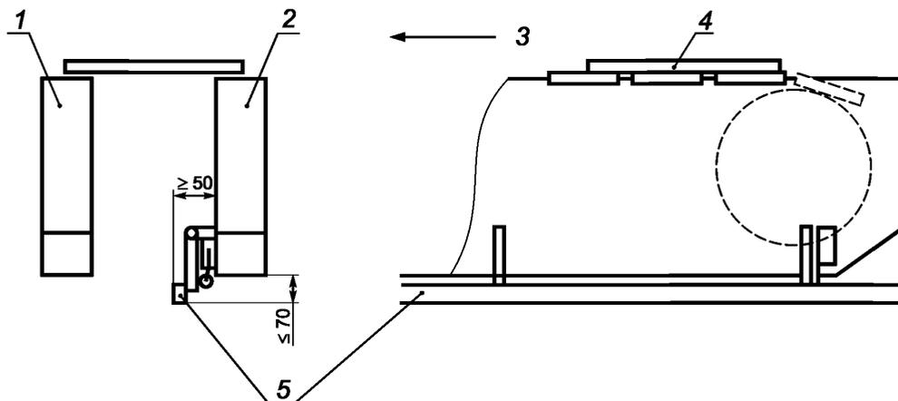
1 — неподвижная балка цепи; 2 — движущаяся балка цепи; 3 — направление подачи; 4 — обрабатываемая заготовка;
