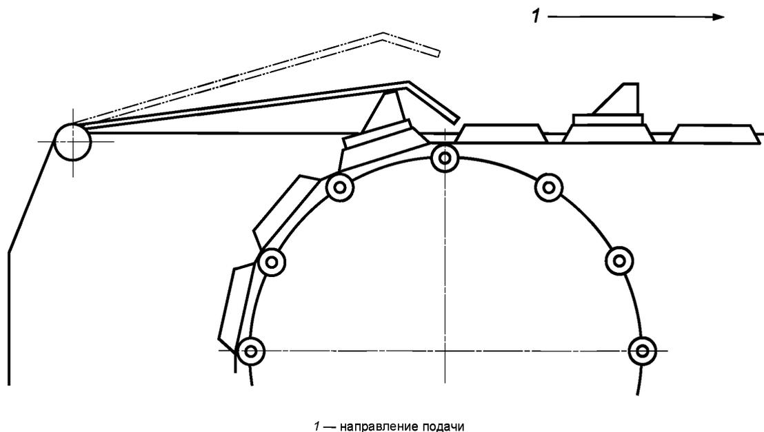
Рисунок 5 — Пример защиты цепи подачи на входе подачи
