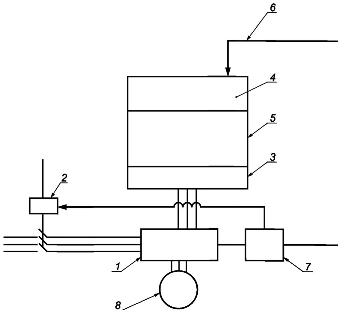
1 — регулятор привода; 2 — регулятор (выключатель) для двигателя; 3 — выходной уровень программируемой электронной системы; 4 — входной уровень программируемой электронной системы; 5 — программируемая электронная система (ПЭС); 6 — петля испытания (обратная связь по скорости); 7 — датчик контроля скорости вращения (двухканальный контроль); 8 — электродвигатель
