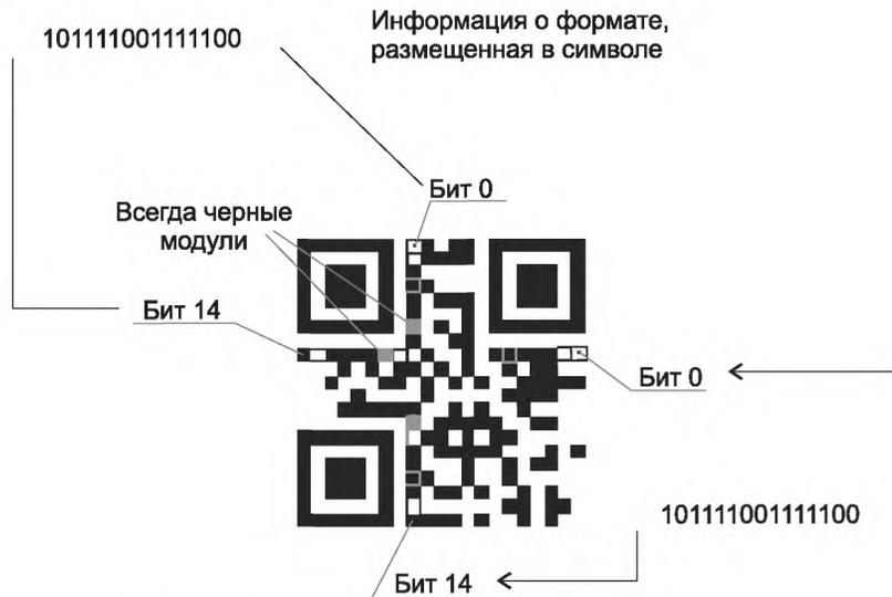
Рисунок I.2 — Окончательный вид символа версии 1-M, кодирующего 01234567
