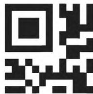
Рисунок I.4 — Окончательный вид символа версии M2-L, кодирующего 01234567
