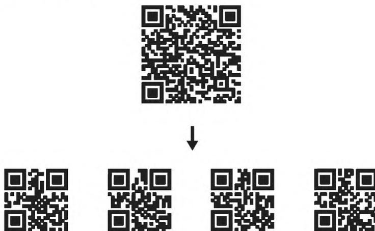
Рисунок 29 – Один символ (сверху) и серия символов структурированного соединения (снизу) кодирующие “ABCDEFGHIJKLMNOPQRSTUVWXYZ0123 456789ABCDEFGHIJKLMNOPQRSTUVWXYZ”
