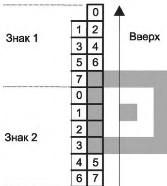
Рисунок 18 – Пример размещения битов, смежных направляющему шаблону
