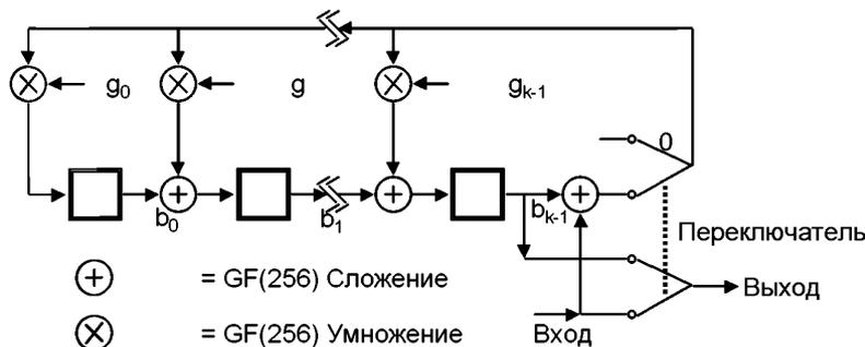
Рисунок 14 — Схема кодирования кодовых слов исправления ошибок
