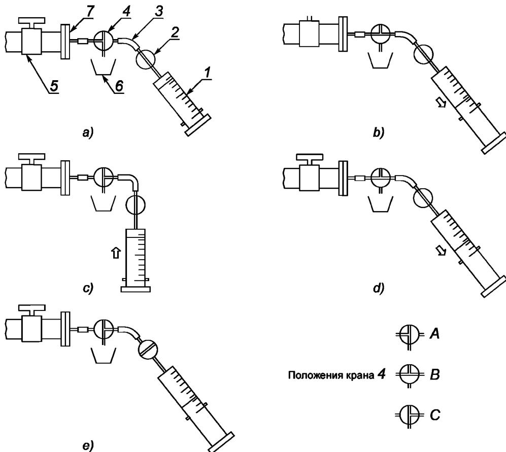
а — промывание; б — смазывание и промывание шприца; в — опорожнение шприца; г — отбор пробы; д — отсоединение шприца; 1 — шприц; 2 — запорный кран; 3 — гибкая соединительная трубка; 4 — трехходовой кран; 5 — пробоотборный кран оборудования; 6 — емкость для отходов; 7 — глухой фланец
