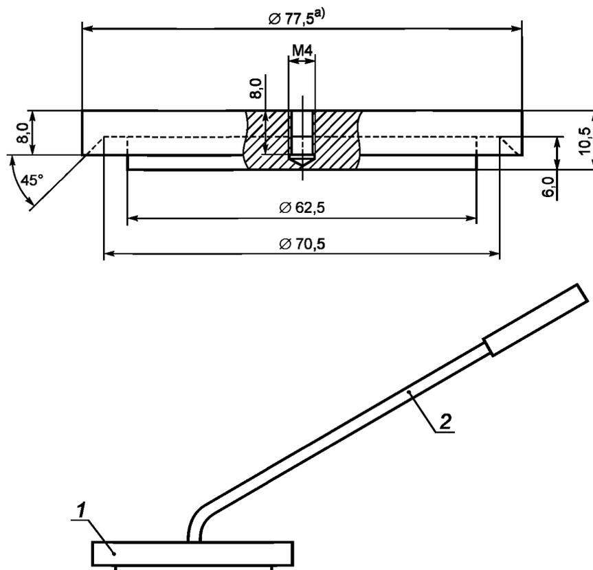
1 — крышка из металла или другого огнестойкого материала; 2 — ручка; <sup>a)</sup> — справочный размер
