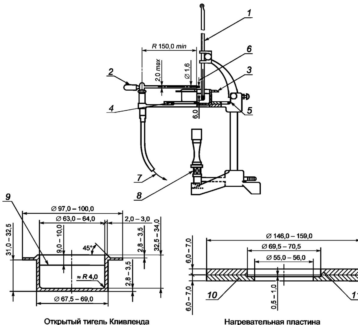
1 — термометр; 2 — зажигательное устройство; 3 — тигель; 4 — металлический шарик диаметром от 3,2 до 4,8 мм; 5 — нагревательная пластина; 6 — отверстие диаметром 0,8 мм; 7 — к источнику газа; 8 — нагревательный прибор пламенного типа или резистивный электронагреватель; 9 — отметка заполнения; 10 — металлическая пластина; 11 — теплостойкая пластина
